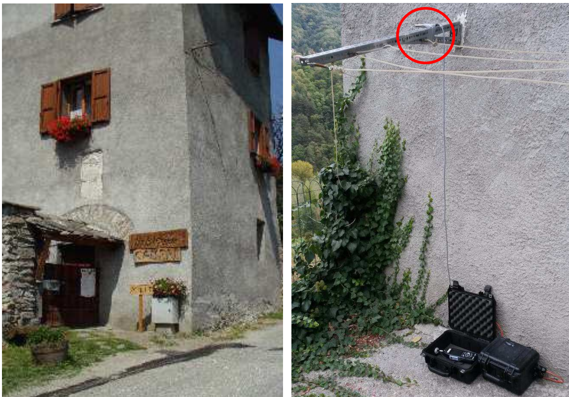
Figura 14 – Fronte ricettore (a sx) e installazione microfono (a dx).
