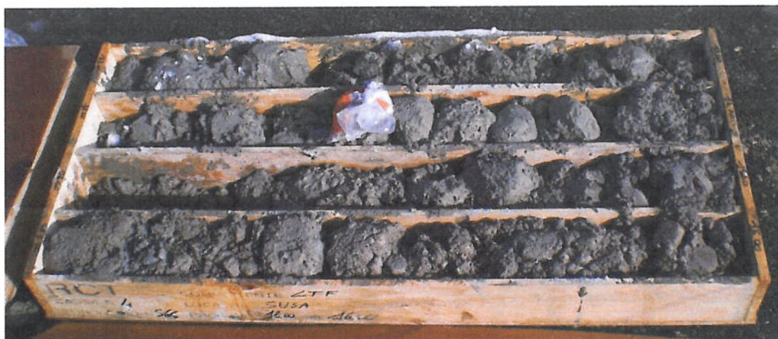
Figura 2 – Sondaggio S66 (prof. 12 – 16 m): litofacies grossolana – Ghiaie e ciottoli con matrice sabbioso e sabbioso-limosa
