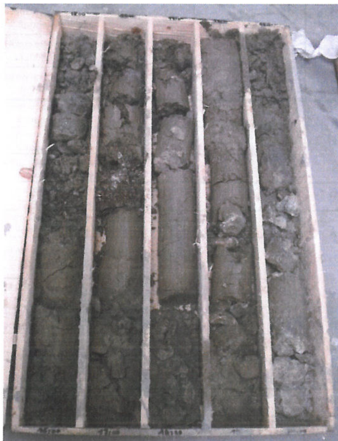
Figura 3 – Sondaggio S72 (prof. 15 – 20 m): ghiaia immersa in abbondante matrice sabbioso-limosa, con passate di sabbia medio – grossolana, con ridotto contenuto in argilla
