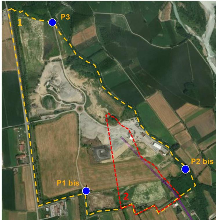
Figura 17: sondaggi eseguiti nel 2015 monitoraggio continuo della falda.
