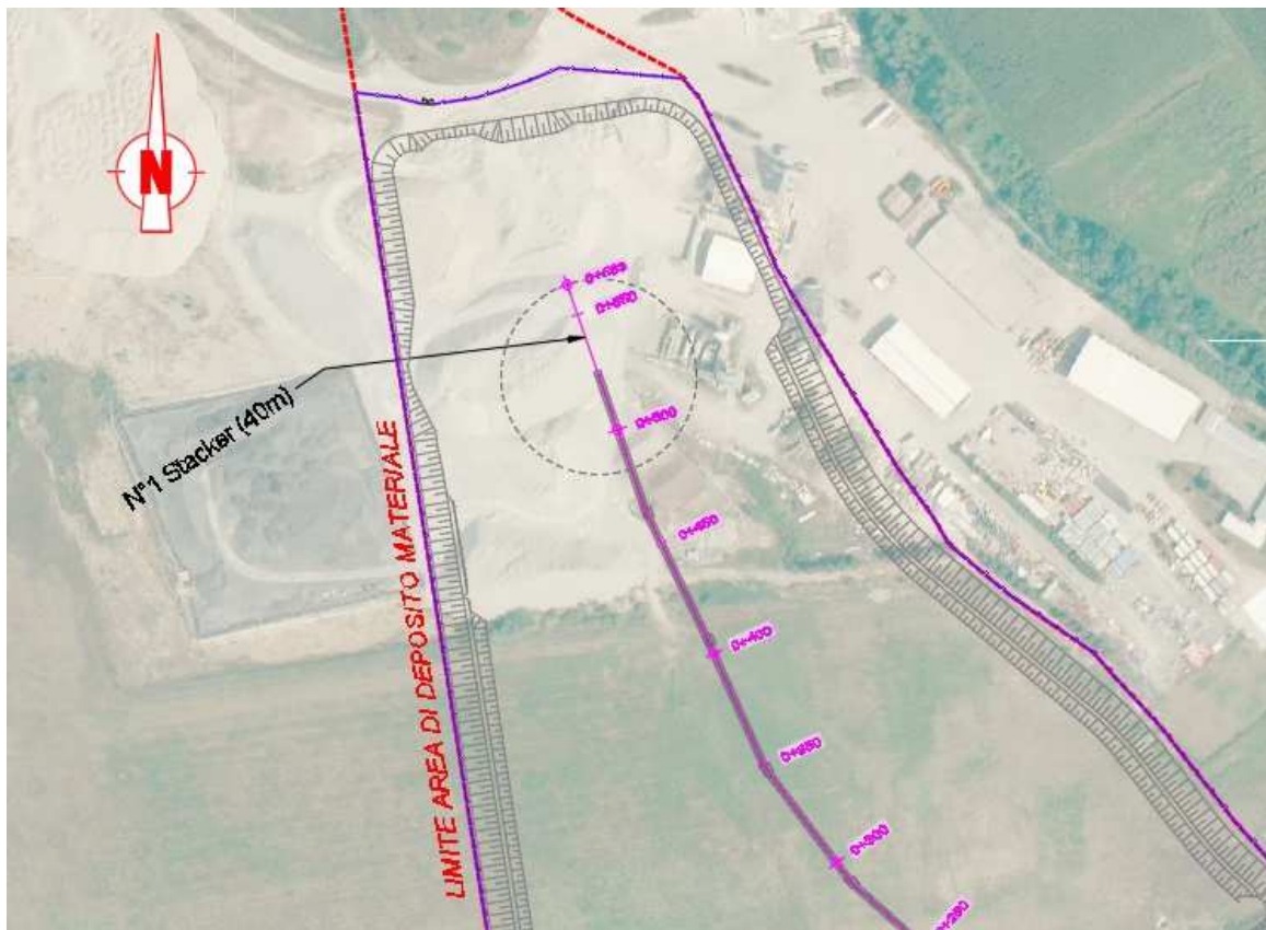
Figura 1 - Interferenza tra nastro trasportatore/sito di deposito e piazzale lavorazione inerti esistente
