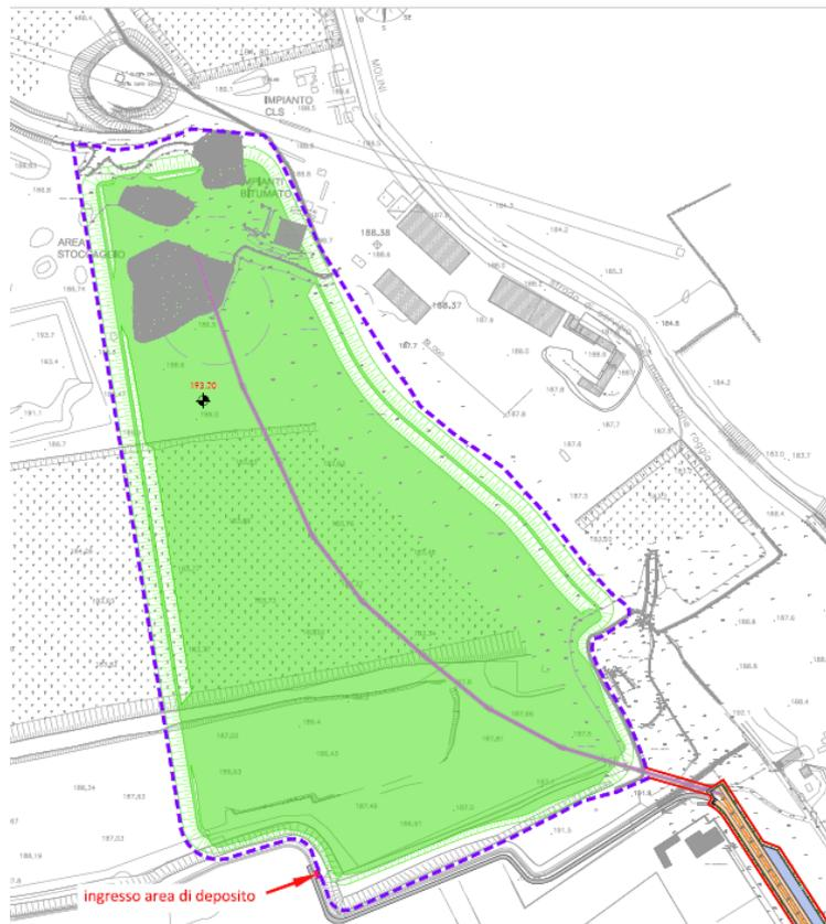
Figura 37: Riempimento area di deposito - FASE 4
