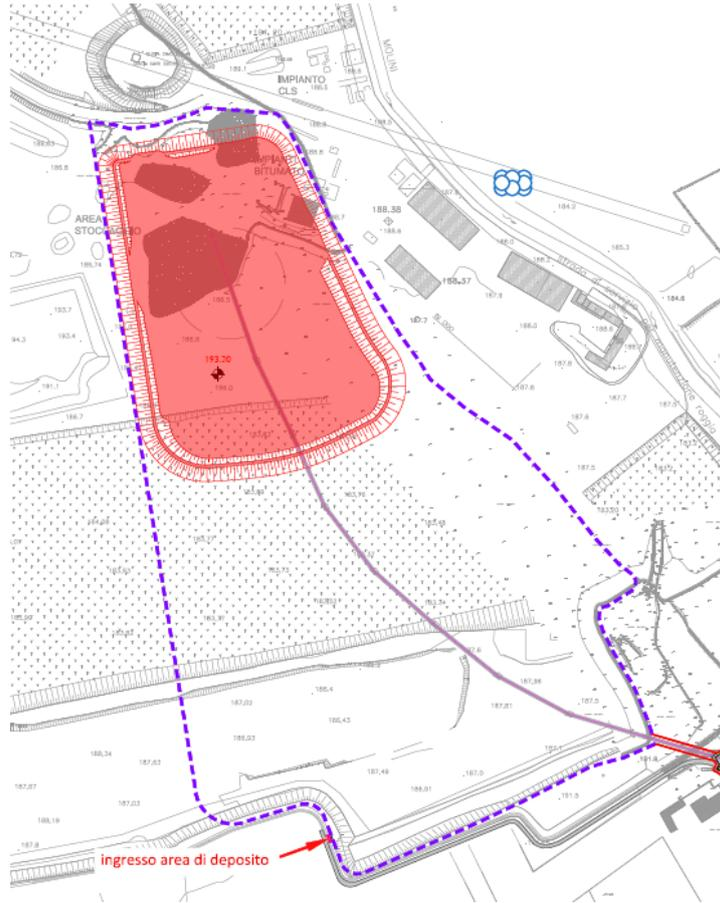
Figura 34: Riempimento area di deposito - FASE 1
