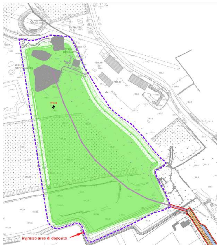
Figura 12: Riempimento area di deposito - FASE 4
