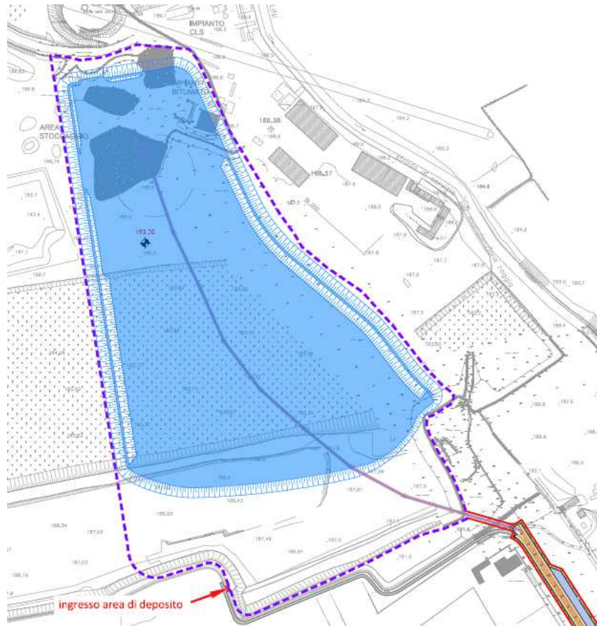
Figura 11: Riempimento area di deposito - FASE 3
