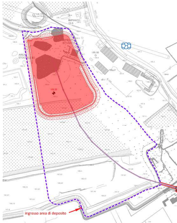
Figura 9: Riempimento area di deposito - FASE 1
