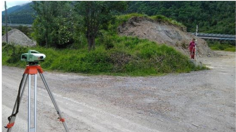
Figura 1 – Esempio di attività di rilievo: misure topografiche sul terreno.
