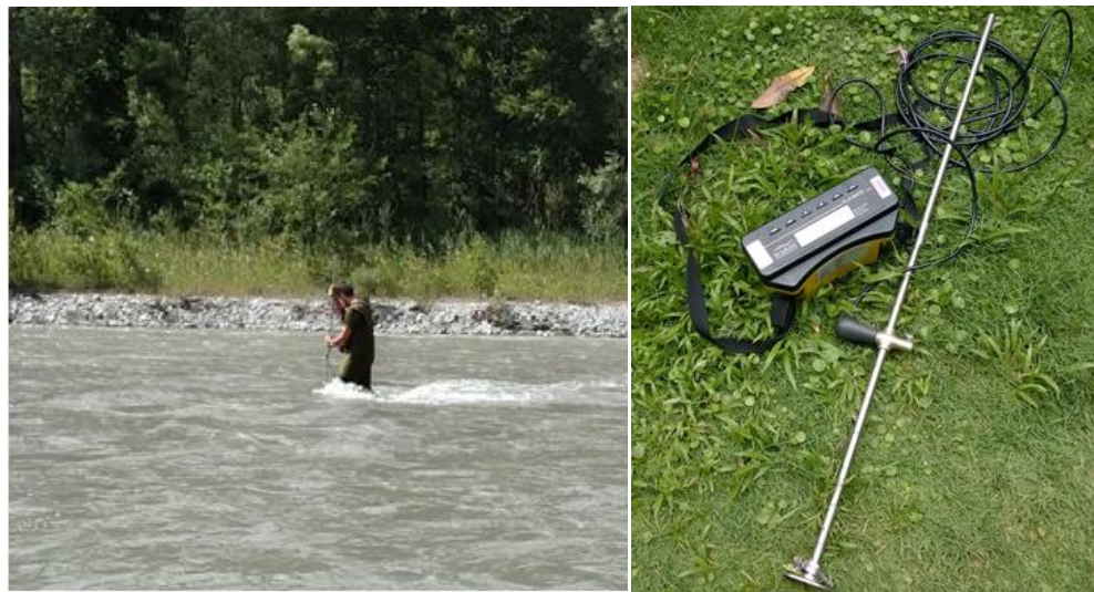
Figura 8 – a) Misura di portata idrica in alveo realizzata con flussometro da campo; b) dettaglio dello strumento utilizzato.
