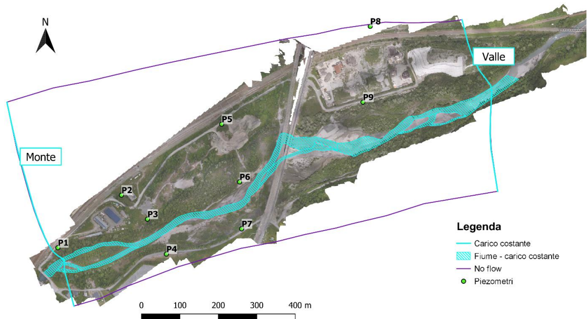
Figura 4.16 – Estensione planimetrica del modello numerico dell'acquifero superficiale e definizione delle condizioni al contorno
