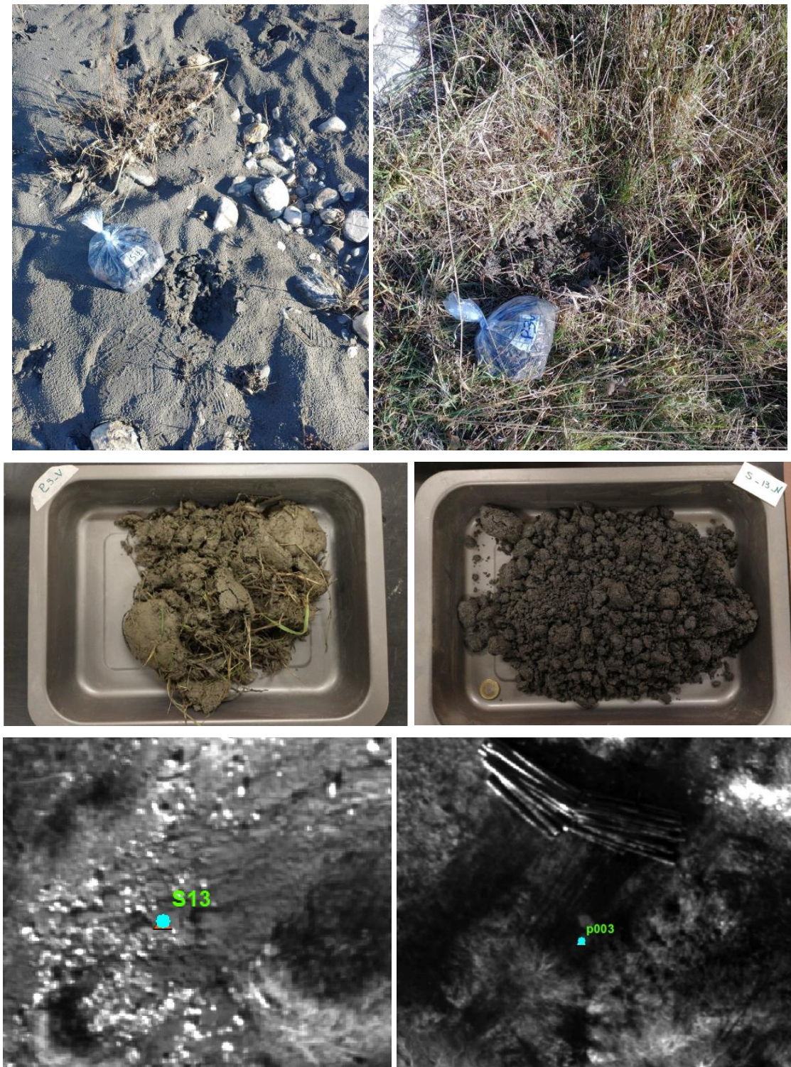
Figura 2.18 - Differenze di riflettanza in base al tipo di vegetazione (I riga), al tipo di suolo (II riga) e all'ombreggiatura (III riga)
