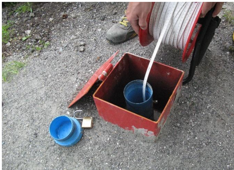
Figura 4.9 – Dettaglio dell'esecuzione del rilievo piezometrico in corrispondenza del piezometro P7.
