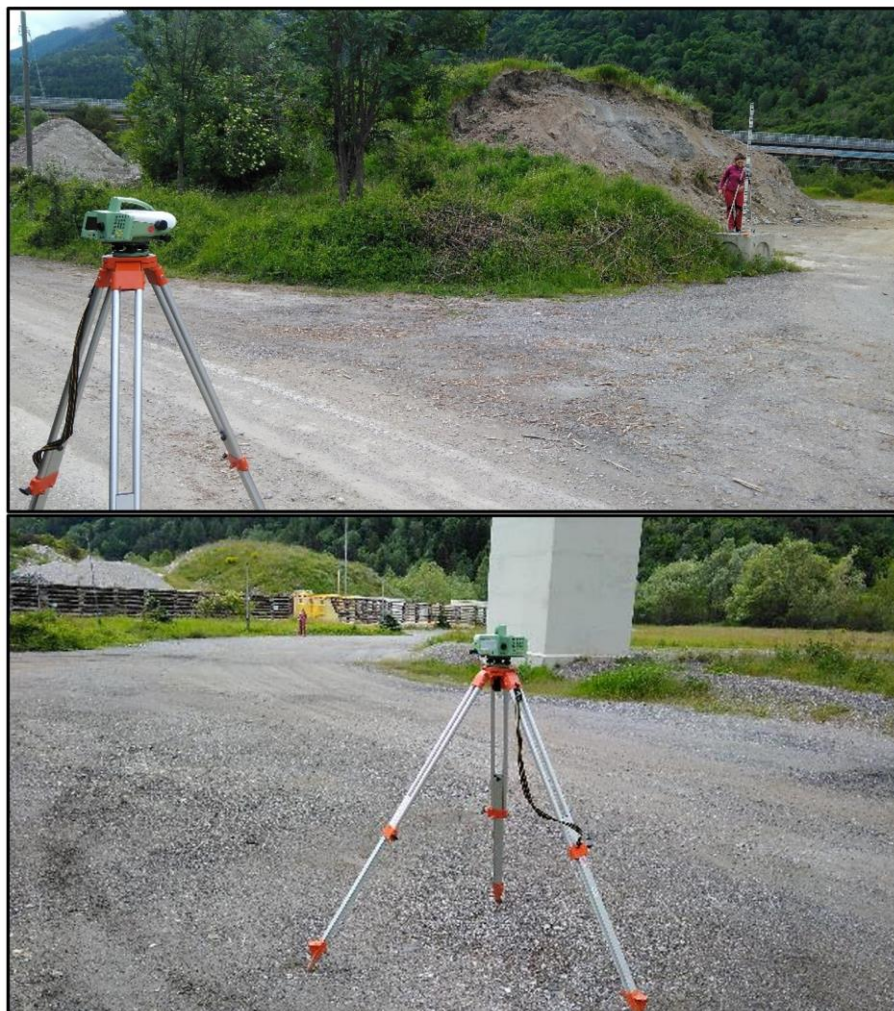
Figura 2.2 – Esempio di battuta della rete di livellazione.
