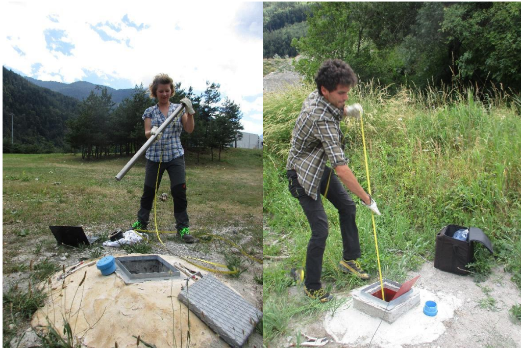
Figura 4.6 – Esecuzione di slug test in risalita presso il sito di Salbertrand: fase preparatoria (sinistra) ed estrazione dello slug (destra)
