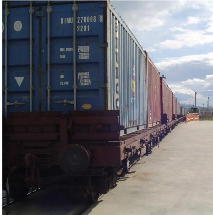
**Figura 3 – Esempio di carro pianale con container open top per trasporto terre**
