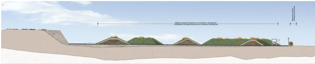
**Figura 36-** Sezione B-B'; dune di scotico inerbite e, sulla destra, siepe arbustiva con finalità mitigative
