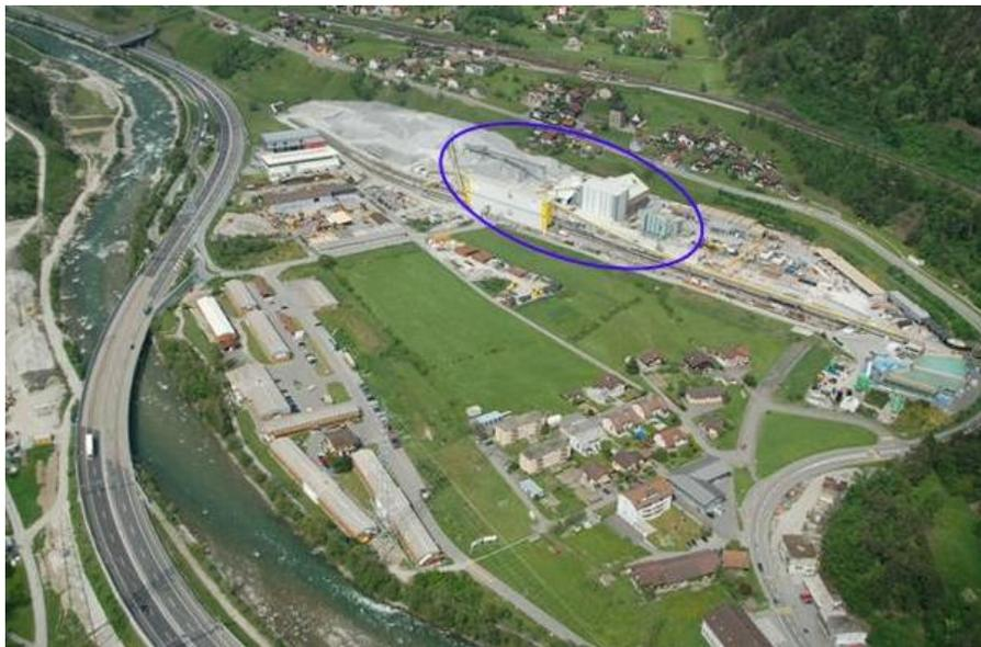
*Figura 7 – Cantiere AlpTransit (Amsteg) – Vista generale del cantiere e (cerchiato in viola) l'impianto di caricamento su treno completamente chiuso*
