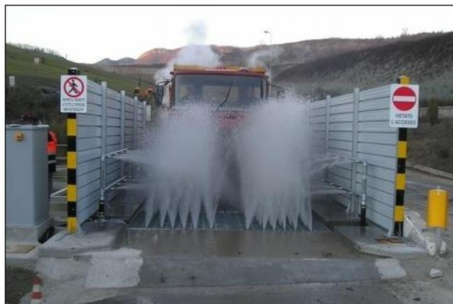
*Figura 13 – Impianto di lavaggio degli autoveicoli e degli automezzi*
