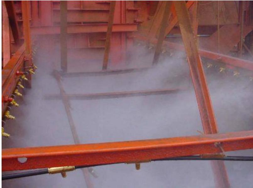
*Figura 10 – Ugelli nebulizzatori in un impianto di frantumazione (Fonte: [www.bgatech.it](http://www.bgatech.it))*
