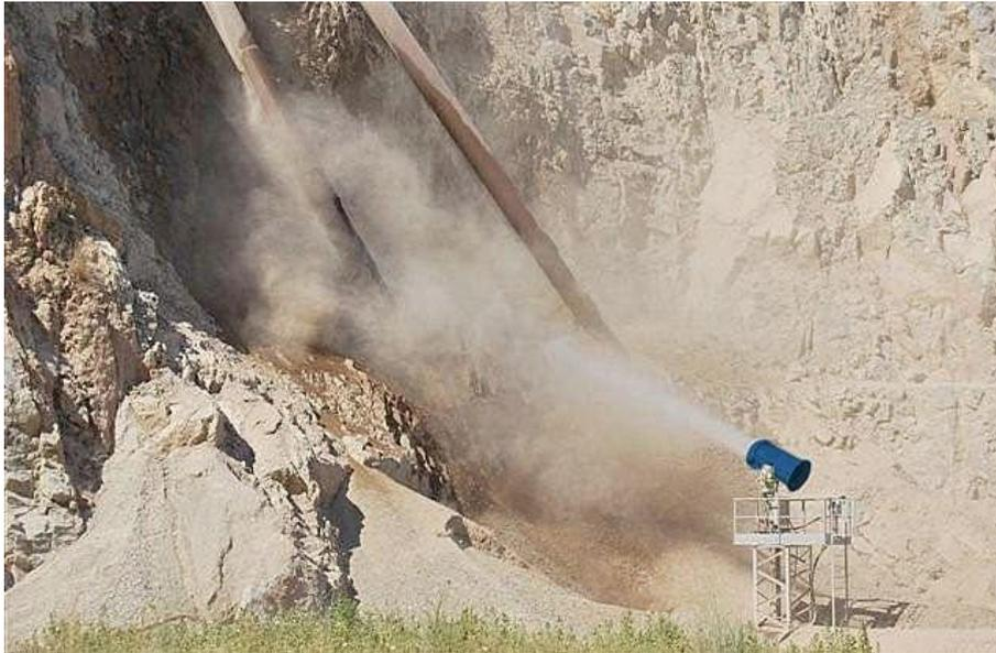
*Figura 9 – Cannone nebulizzatore mobile (Fonte: www.comacenvironment.com)*
