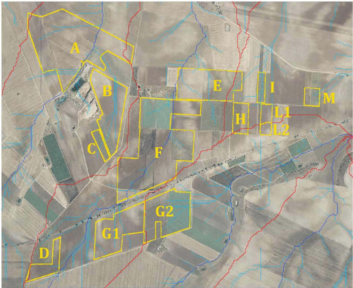
Figura 5.5: Delimitazione bacini scolanti e codifica (giallo), reticolo di drenaggio esterno ed interno alle sezioni di progetto (blu) e limiti bacini idrografici (rosso).
