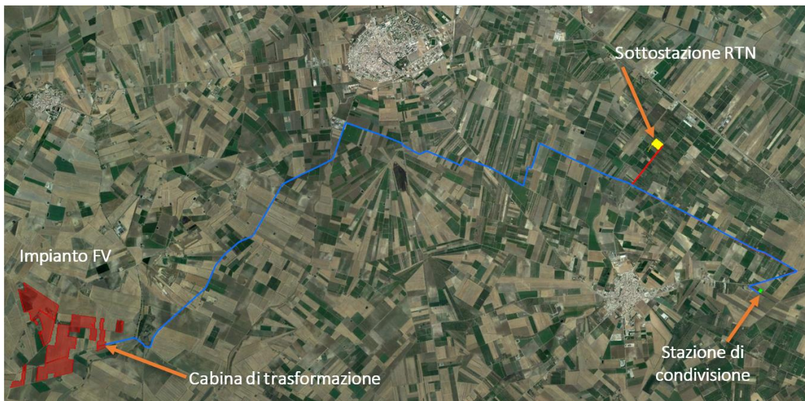
Figura 4.2: Elementi principali della linea di connessione.
