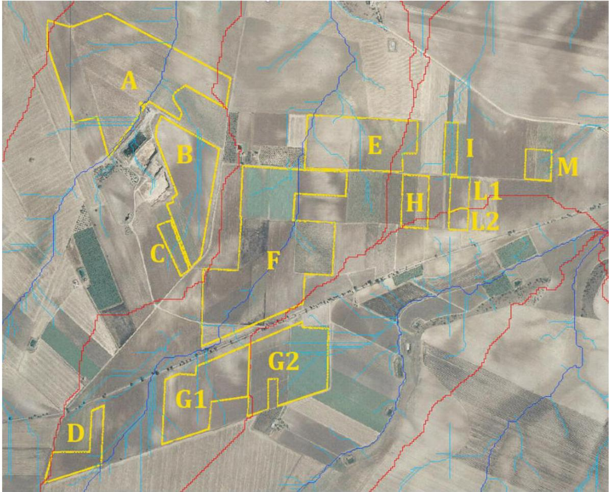
Figura 6.9: Delimitazione recinzione di impianto (giallo), rete di drenaggio naturale interna (blu) e spartiacque (rosso).
