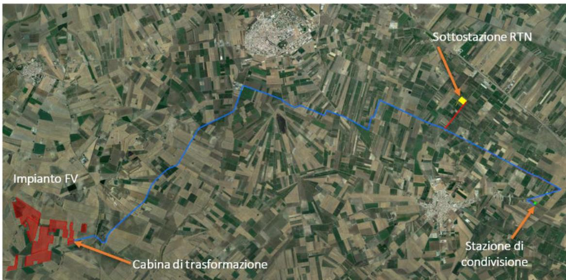
Figura 4.2: Elementi principali della linea di connessione.
