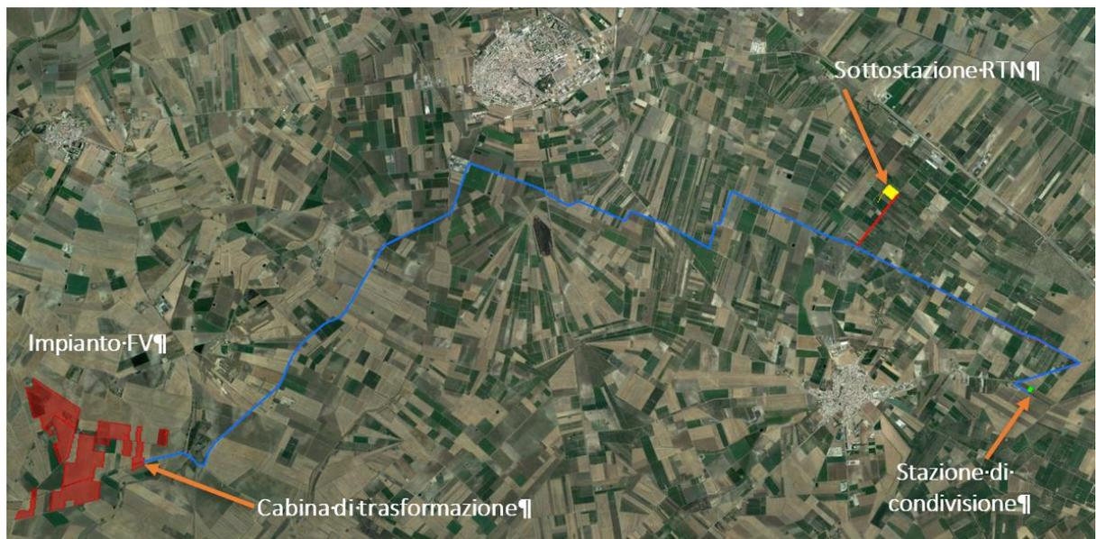
Figura 2.13: In viola il percorso di connessione dal campo FV alla cabina di trasformazione e in blu il successivo collegamento alla Sottostazione AT di Stornara
