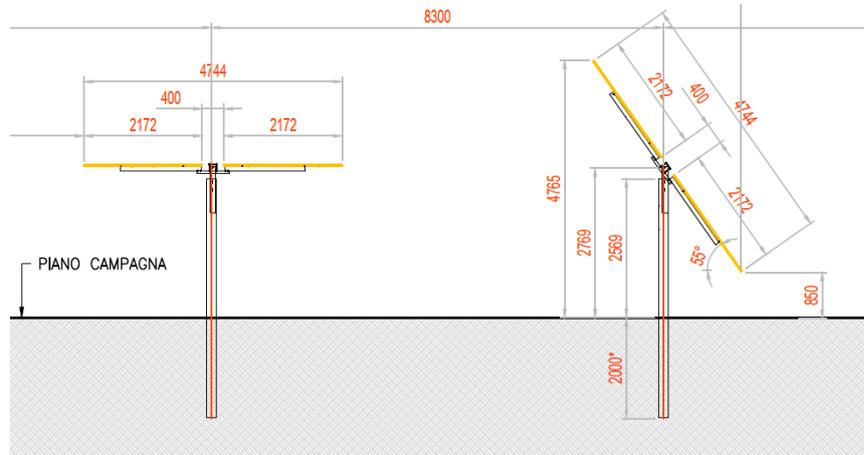
Figura 2.8: Particolare strutture di sostegno moduli
