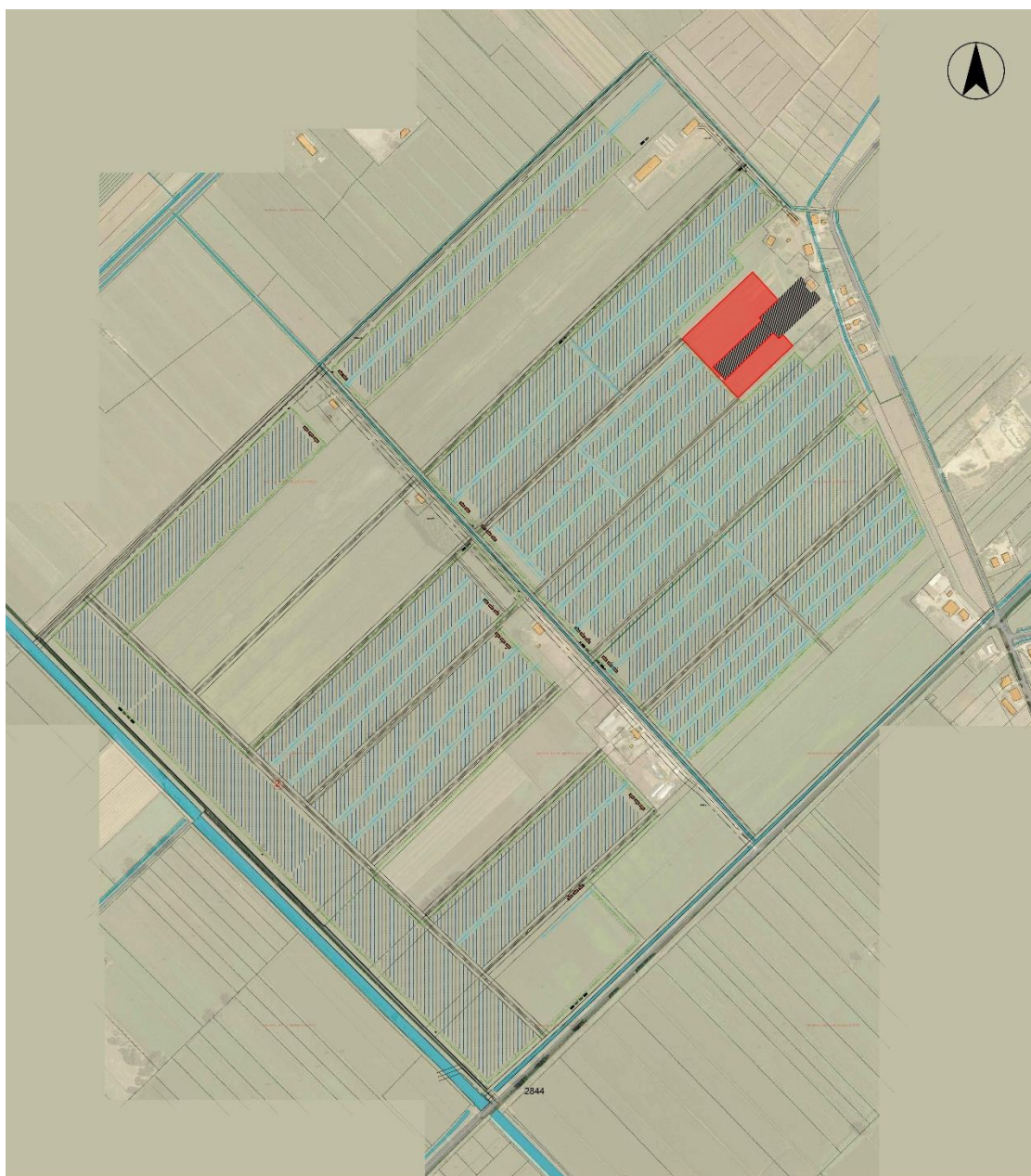
Figura 2 - Layout impianto agrovoltaico con pensiline verticali
