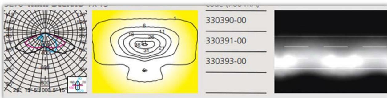
**La fotometrica di emissione a 90° rispetto al piano di emissione sarà inoltre pari a zero: nel caso specifico il proiettore presenta una fotometrica pari a zero già a 75°:**
