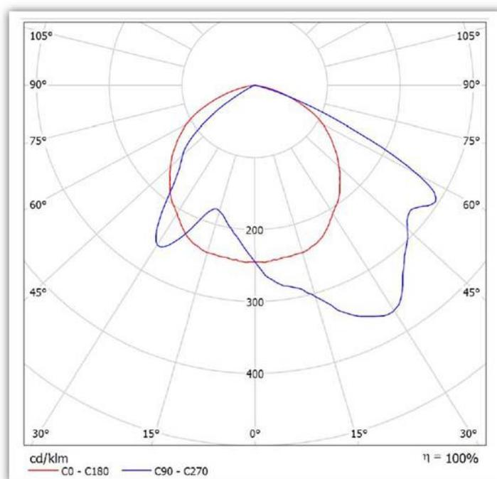
Ogni palo sarà dotato di una sola sorgente luminosa con ottica parallela al terreno, con emissione luminosa pari a circa **6000lm** alla temperatura di colore di **4000k** ed alla corrente d'impiego di **350mA**.
