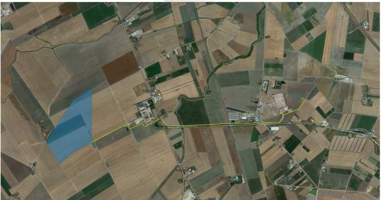
Figura 2-3: Impianto e tracciato di Elettrodotto su Ortofoto
