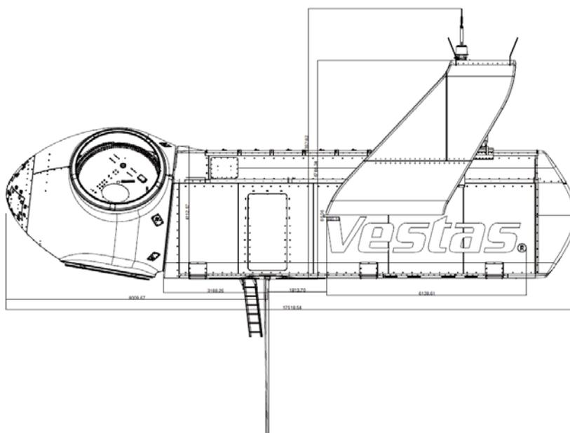
I componenti principali degli aerogeneratori sono costituiti dal rotore, dal sistema di trasmissione, dal generatore, dal sistema di frenatura, dal sistema di orientamento, dalla gondola e dalla torre. L'albero principale trasmette la potenza al generatore tramite un sistema di riduzione. Tale sistema è composto da uno stadio planetario e 2 stadi elicoidali.
