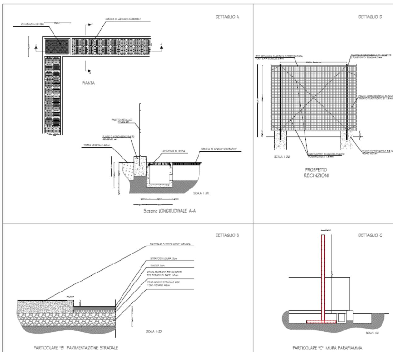
I plinti verranno gettati in buche ricavate nel terreno ad una profondità non inferiore a 40 cm, in tal modo il plinto emergerà dal piano di calpestio stradale per 20 cm, costituendo così una spalla di appoggio al cordolo perimetrale dell'aiuola. I paletti sono disposti ad interasse non superiore a 2,00 m e la maglia è irrigidita da una controventatura in tiranti metallici disposti a croce e ancorati ai paletti.
