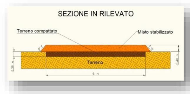
La viabilità di cantiere si concretizzerà nella apertura di piste carrabili in sterrato opportunamente stabilizzato, a carattere provvisorio ed ad ultimazione dei lavori verrà rimosso lo strato di stabilizzante al fine di consentire il normale utilizzo del suolo ante operam, lasciando esclusivamente un ridotto passaggio carrabile per la manutenzione.
