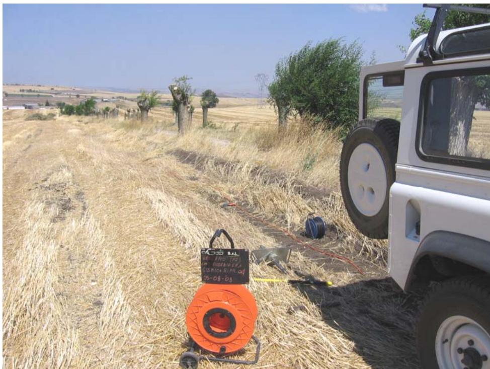
ubicazione stendimento sismico n.4 (parallelo strada, origine NE, fine SW)
