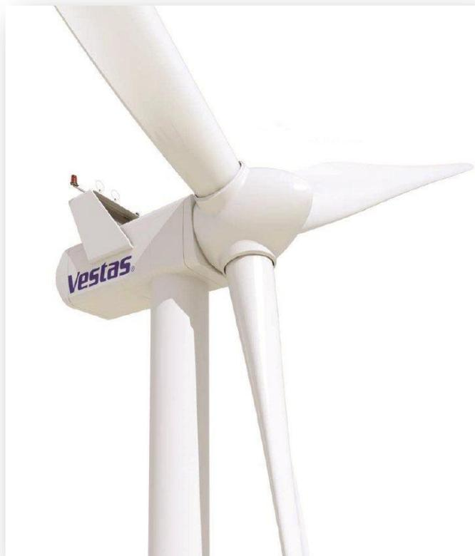
La macchina prescelta è ad asse orizzontale, come già specificato precedentemente, in cui il sostegno (torre) porta alla sua sommità la navicella, costituita da un basamento e da un involucro esterno. All'interno di essa sono contenuti l'albero di trasmissione lento, il moltiplicatore di giri (eventuale), l'albero veloce, il generatore elettrico ed i dispositivi ausiliari. All'esterno della gondola, all'estremità dell'albero lento, è montato il rotore,
