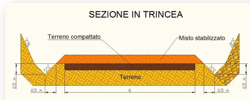
La viabilità di cantiere si concretizzerà nella apertura di piste carrabili in sterrato opportunamente stabilizzato, a carattere provvisorio ed ad ultimazione dei lavori verrà rimosso lo strato di stabilizzante al fine di consentire il normale utilizzo del suolo ante operam, lasciando esclusivamente un ridotto passaggio carrabile per la manutenzione.
