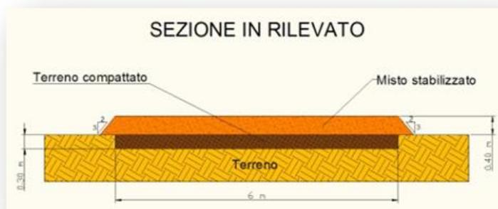
La viabilità di cantiere si concretizzerà nella apertura di piste carrabili in sterrato opportunamente stabilizzato, a carattere provvisorio ed ad ultimazione dei lavori verrà rimosso lo strato di stabilizzante al fine di consentire il normale utilizzo del suolo ante operam, lasciando esclusivamente un ridotto passaggio carrabile per la manutenzione.
