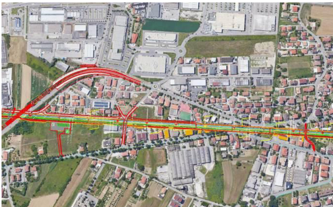
Figura 12– Raddoppio ferroviario dal km 4+550 al km 5+600 Tra il km 4+700 ed il km 5+000 il P.M. di San Giovanni Teatino si affianca alla strada statale n°5 sul lato destro e via Vittorio Emanuele sul lato sinistro. Il tracciato è stato studiato mantenendo una distanza costante tra i binari di progetto più esterni ed i cigli di ciascuna viabilità stradale posta in adiacenza agli stessi.
