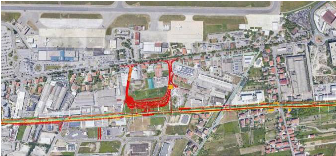
Figura 8- Raddoppio ferroviario dal km 2+400 al km 3+200
