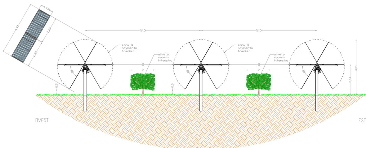
Fig. n°1 Sistema Agro-fotovoltaico
