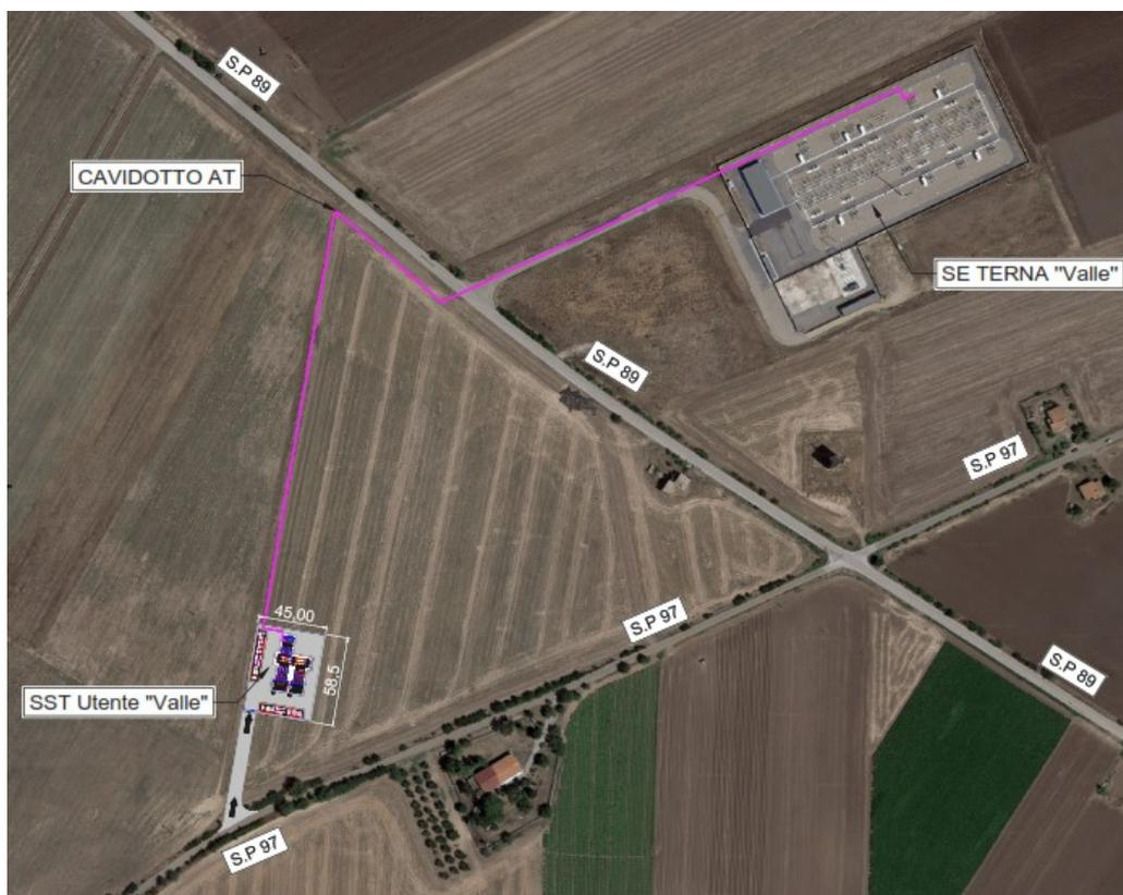
Fig.7 Ortofoto ubicazione Sottostazione Utente e Stazione Terna
