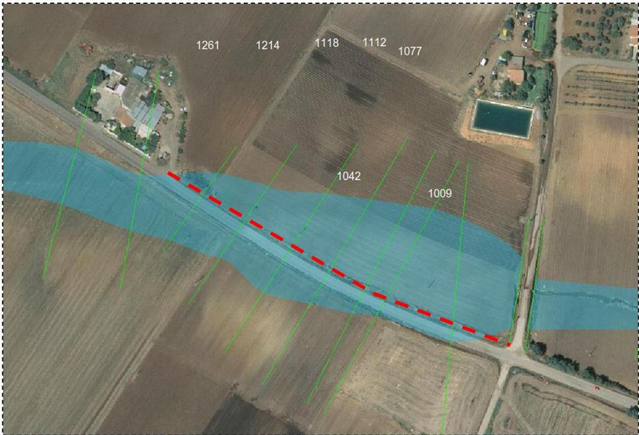
Fig. 10 Area "A". Particolare del tratto di cavidotto a realizzarsi con tecnica T.O.C
