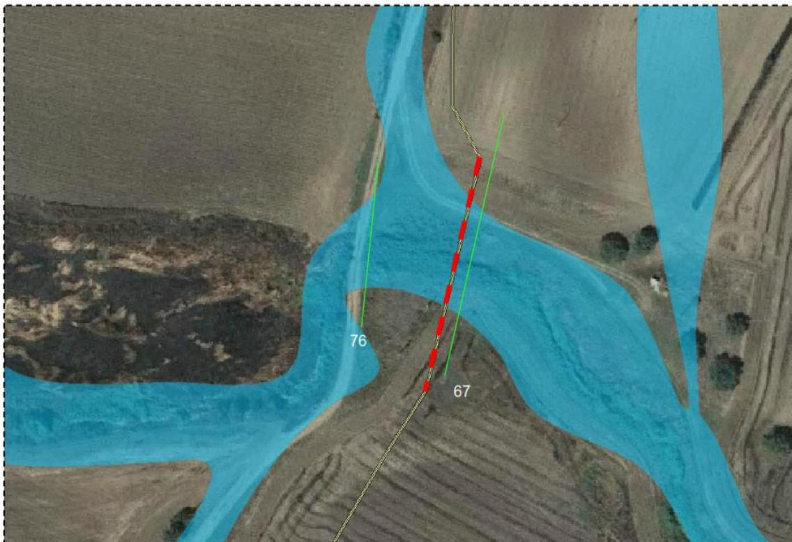
Fig. 21 Area "E Centro". Particolare del tratto di cavidotto a realizzarsi con tecnica T.O.C
