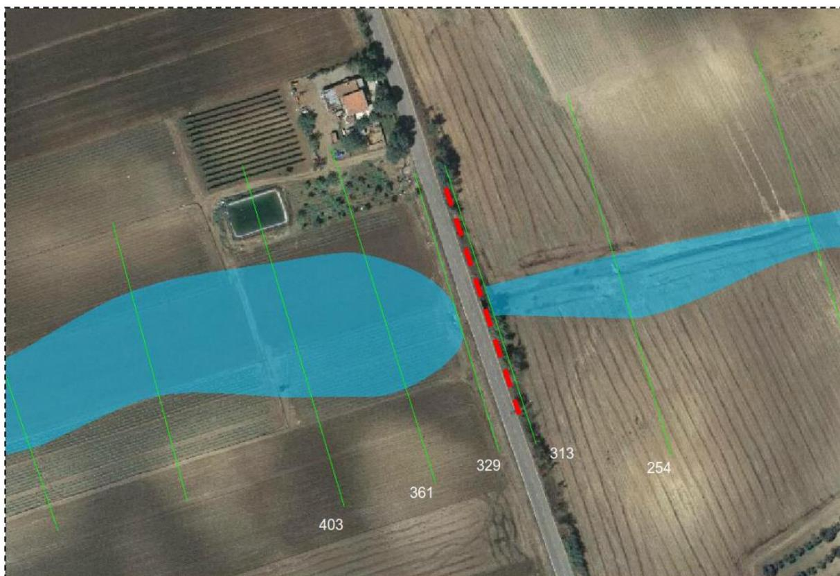
Fig. 13 Area "B". Particolare del tratto di cavitto a realizzarsi con tecnica T.O.C
