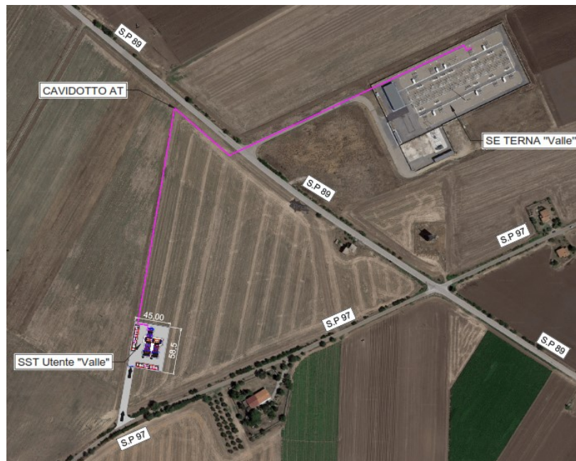
Fig. 9 Ortofoto ubicazione Sottostazione Utente e Stazione Terna
