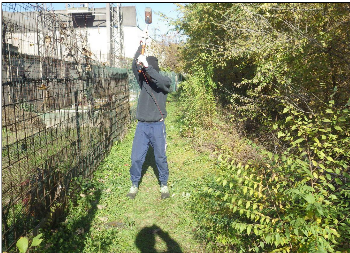
Fig. 7 – Energizzazione con massa battente.
