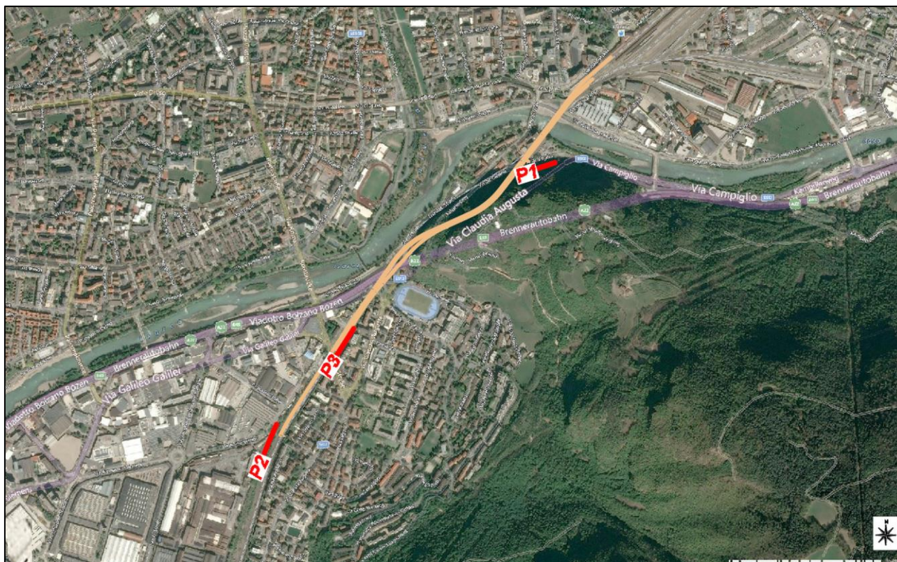
Fig. 6 - Ubicazione territoriale indagini sismiche a rifrazione P – S rispetto al tracciato ferroviario in progetto e su foto aerea.
