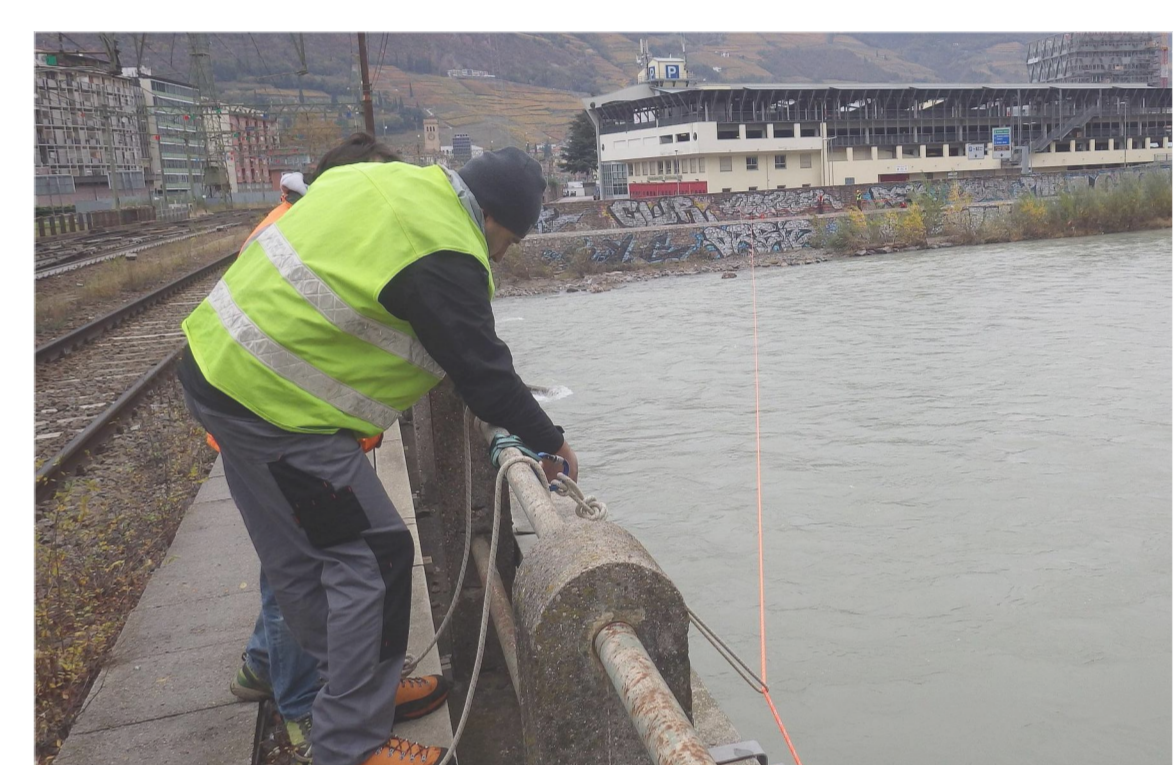
Attività di preparazione per l'attraversamento del F. Isarco con la stesa degli elettrodi
