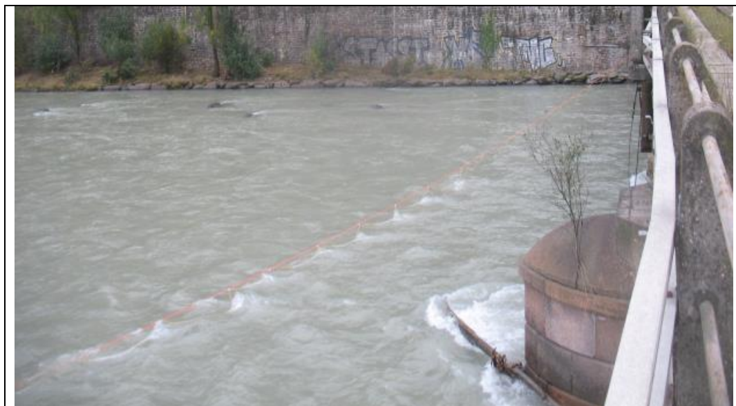
Fig. 8 – Fase di registrazione con gli elettrodi posti a contatto con il pelo libero dell’acqua, sponda destra F. Isarco
