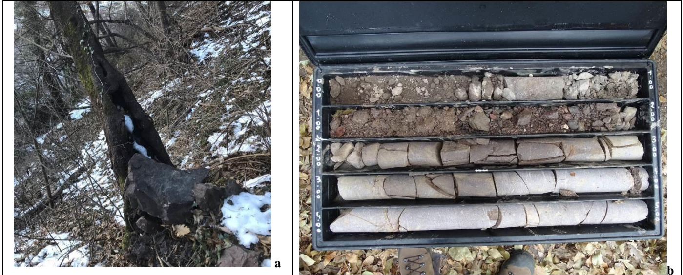
Figura 38. Esempio di falda detritica con blocchi decimetrici (a); carote dell'intervallo di profondità 0-5 m del sondaggio BHG3 (b); i primi due metri sono attribuibili ai depositi PTG.
