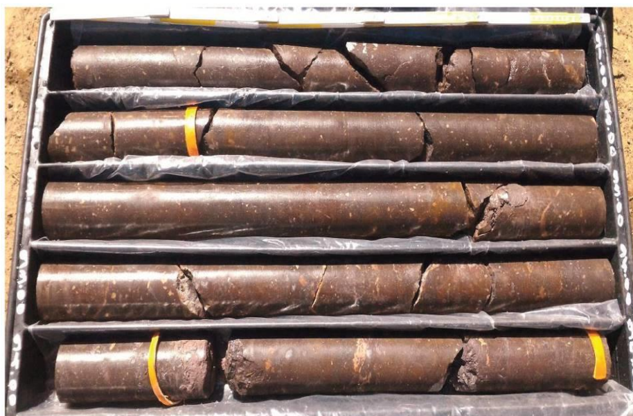
Figura 35. Lave andesitiche (AND) rinvenute nel sondaggio BHG7. In figura la cassa compresa tra 90 e 95 m di profondità.
