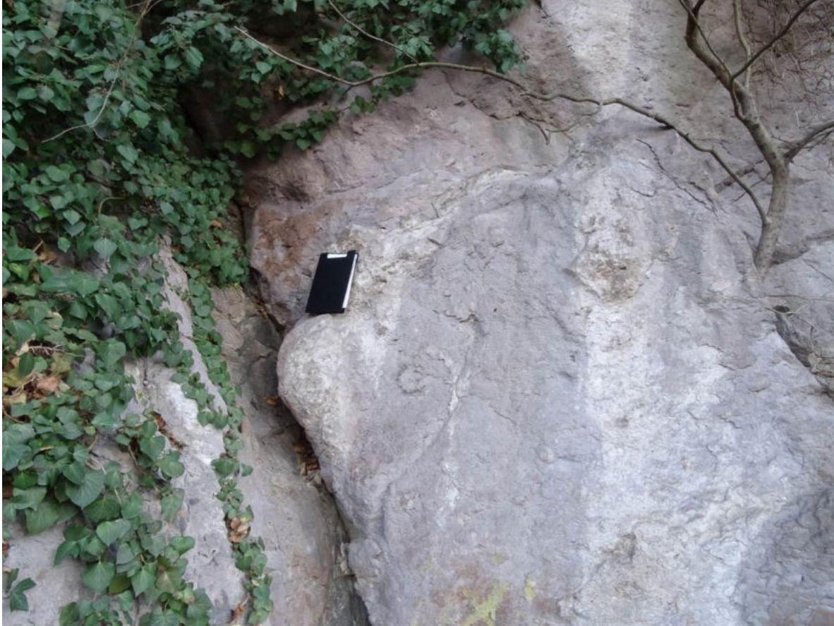
Figura 124. Affioramento ignimbrico IGR alla base di Via del Calvario, con apprezzabile grado di alterazione
