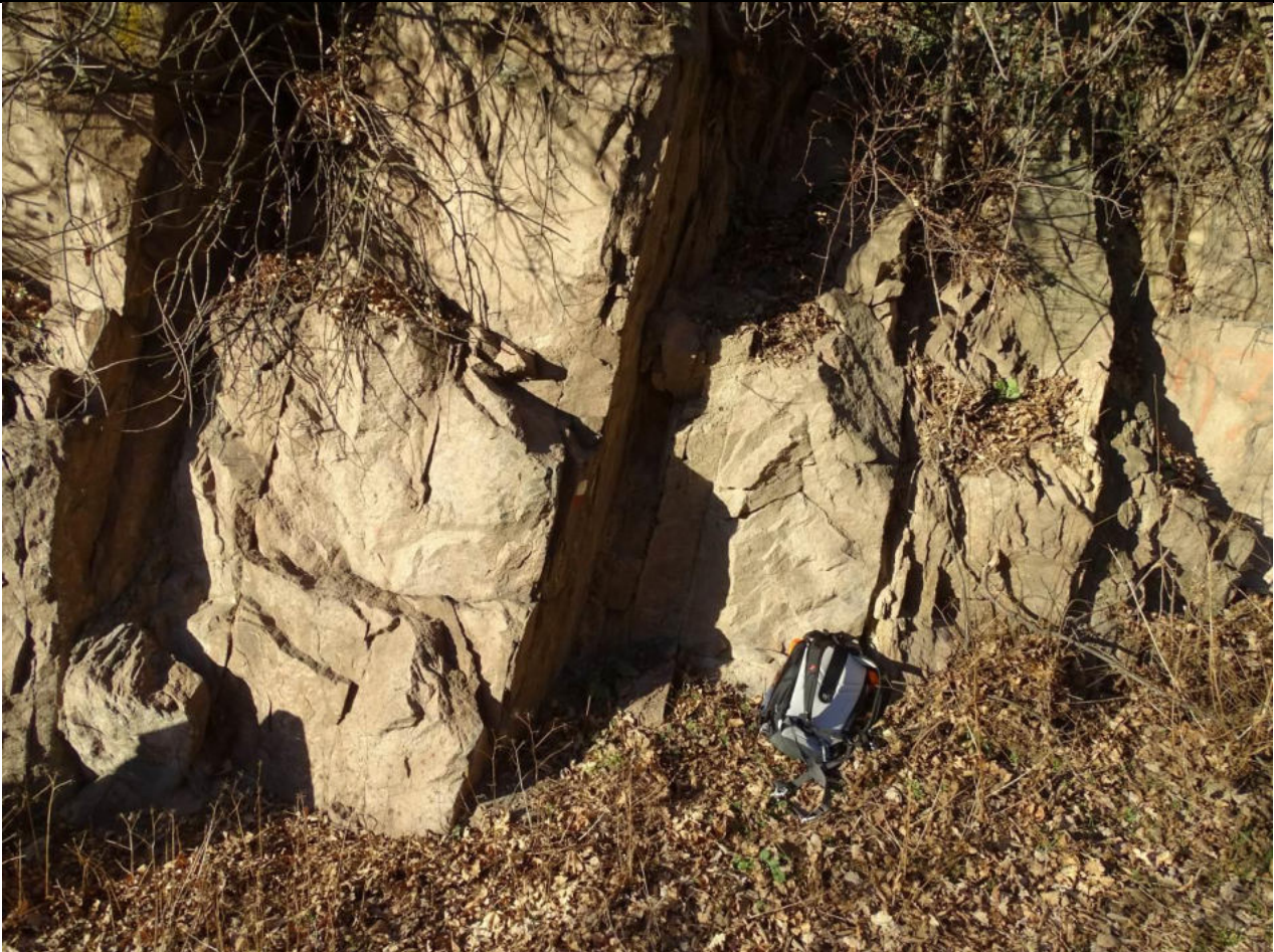
Figura 31. Superfici di discontinuità nell'ignimbrite di Ora
