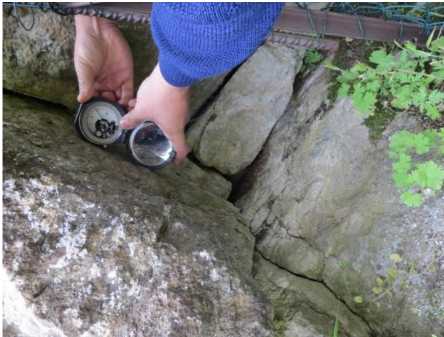
Figura 2. Rilievo dell'inclinazione dello strato.
