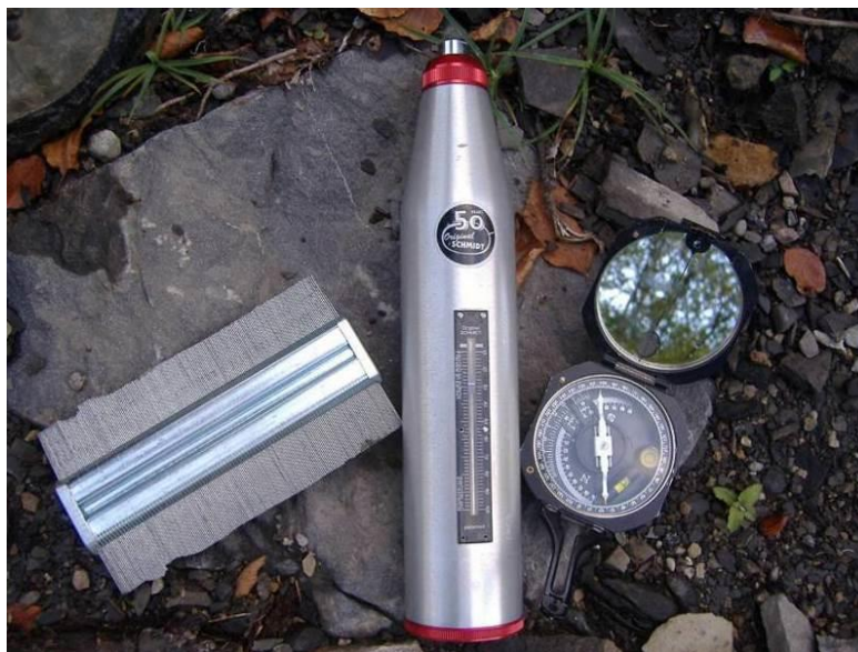
Figura 8. Da destra: profilometro, sclerometro da roccia e bussola da geologo.
