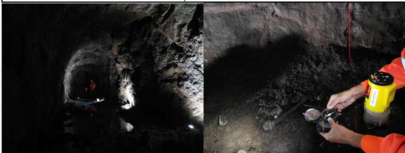
**Figura 4-3. Fase operativa di misura della orientazione della mezzeria del cunicolo dei vari segmenti individuati.**
