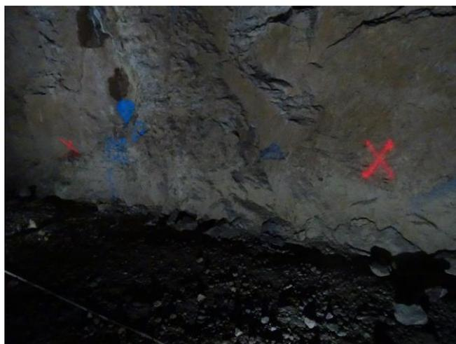
**Figura 4-4. Piani campione a giacitura nota misurati direttamente in cunicolo e marcati con vernice ad alta visibilità.**
