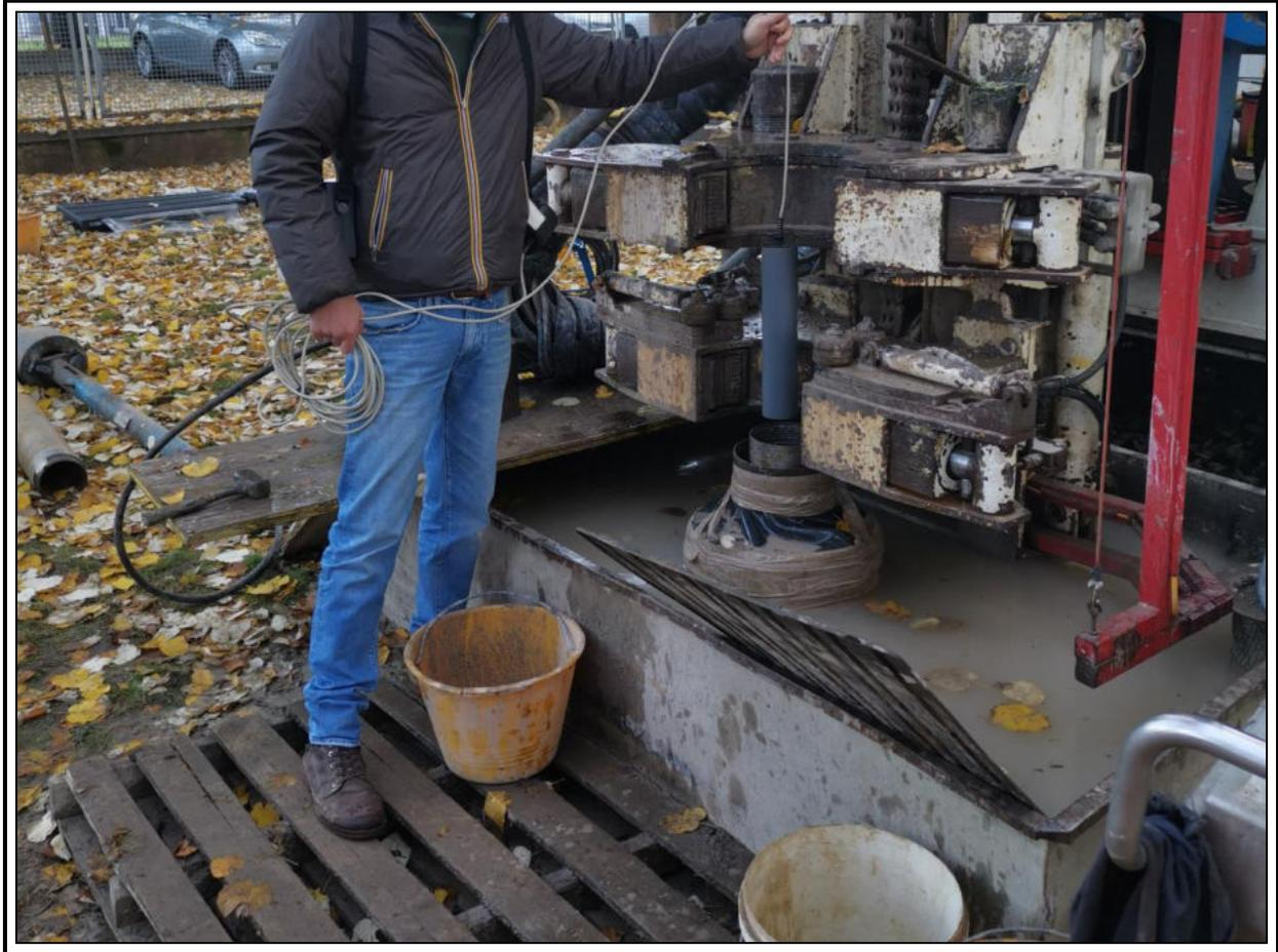
**Sondaggio VG4-Rilievo masse metalliche in foro**
