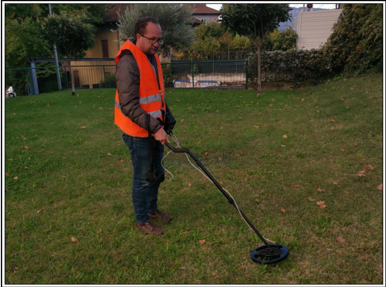
**Sondaggio VG2-Rilievo masse metalliche**
