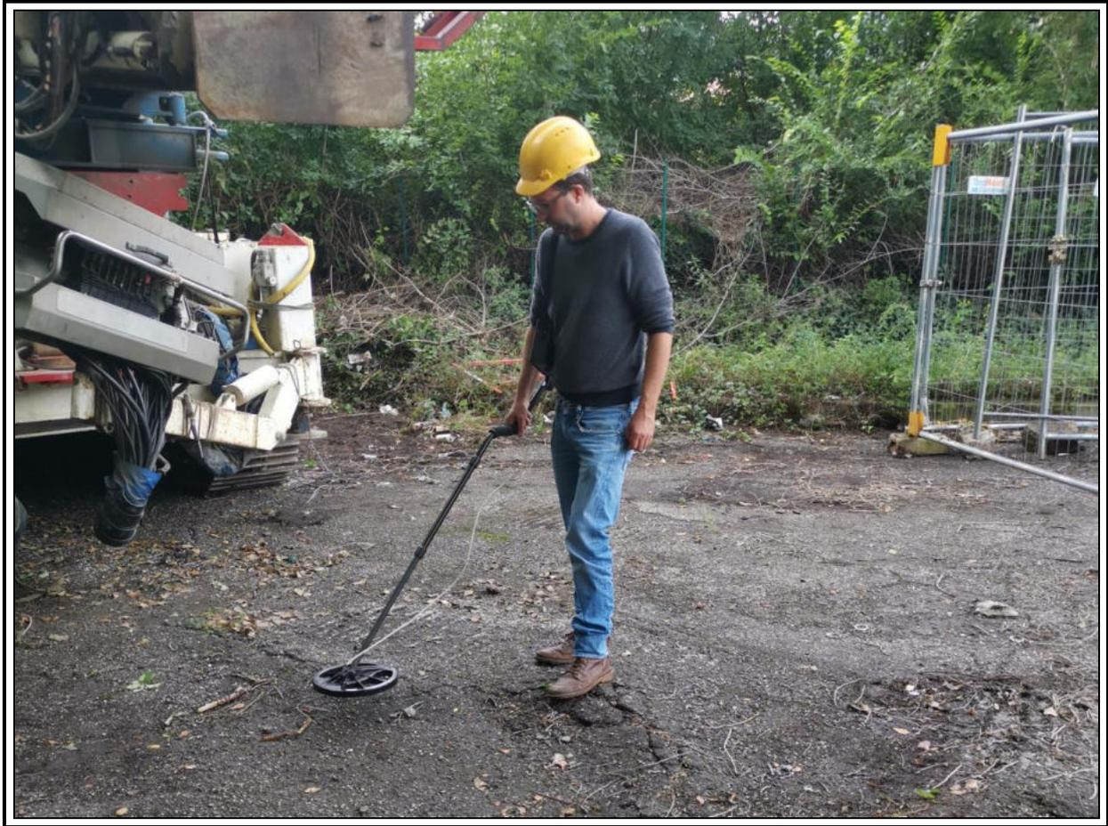
**Sondaggio VG1-Rilievo masse metalliche**
