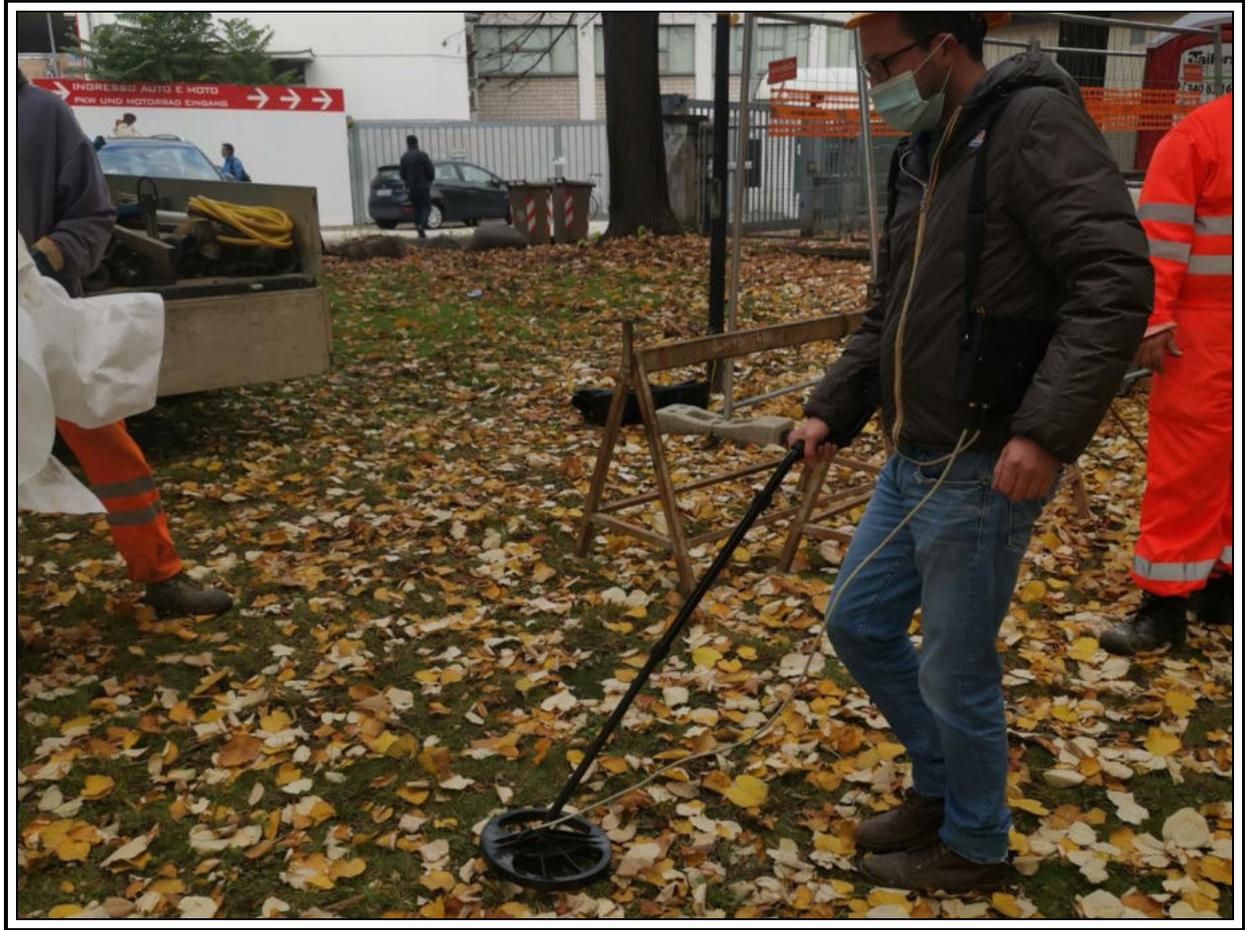
**Sondaggio VG4-Rilievo masse metalliche**
