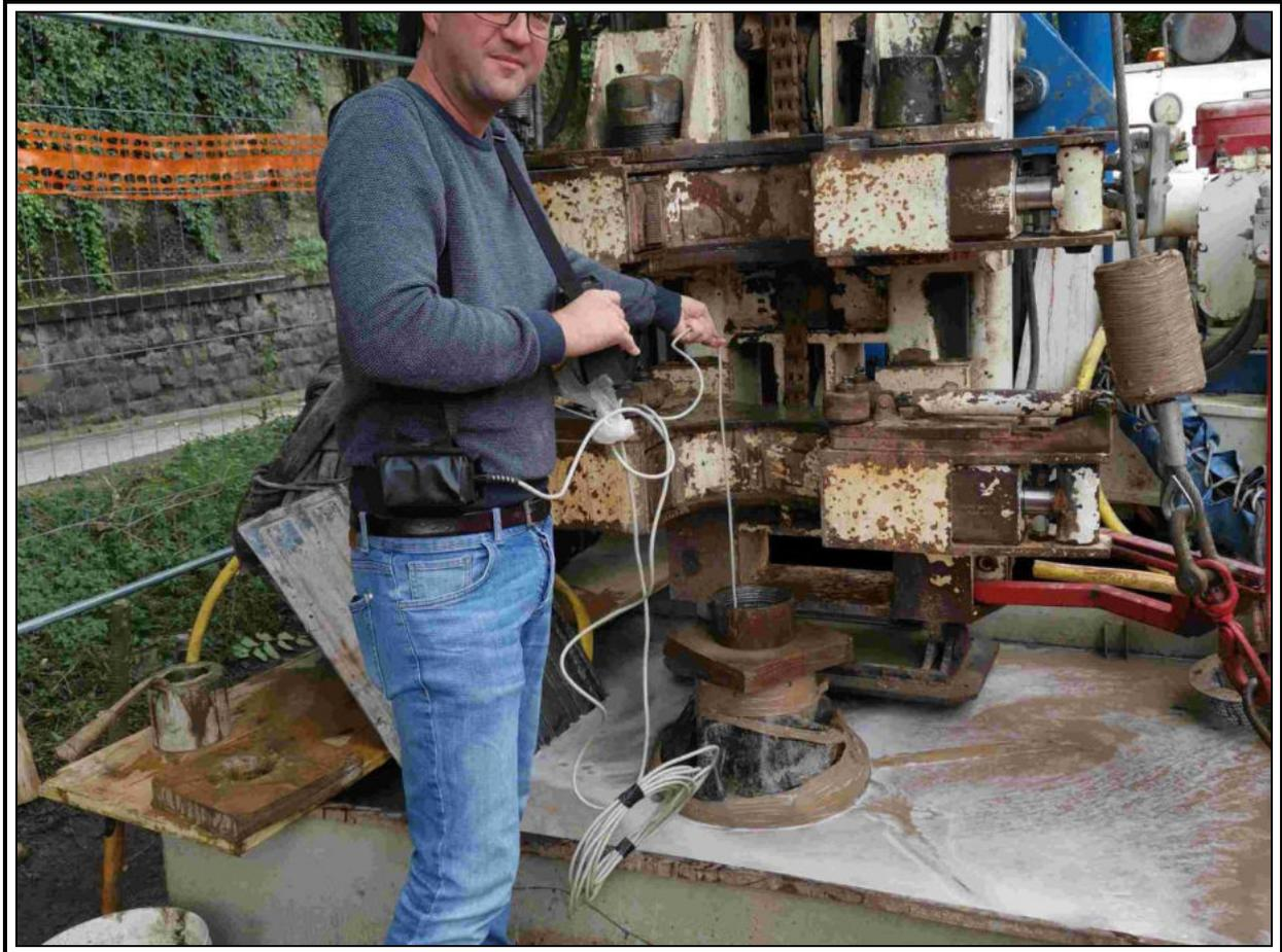
**Sondaggio VG1-Rilievo masse metalliche in foro**
