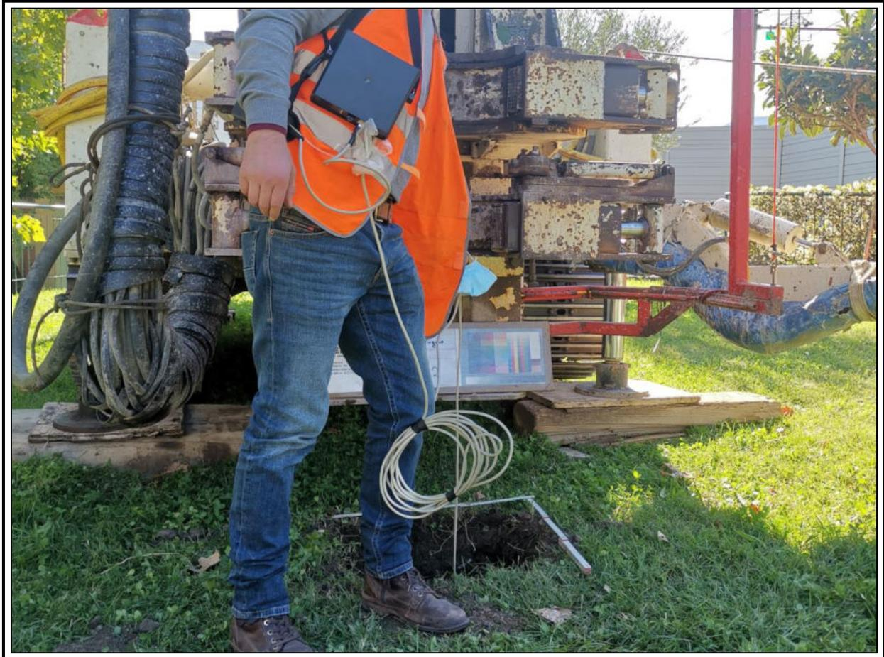
**Sondaggio VG2-Rilievo masse metalliche in foro**
