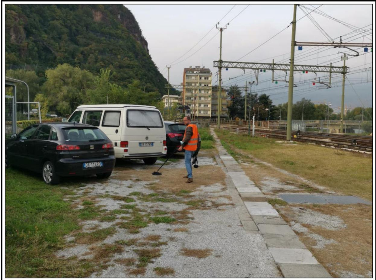
**Sondaggio VG0-Rilievo masse metalliche**
