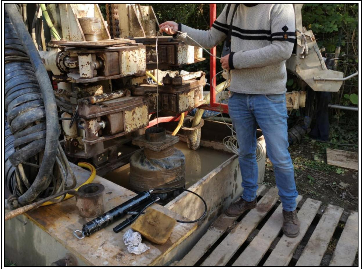
**Sondaggio VG3-Rilievo masse metalliche in foro**
