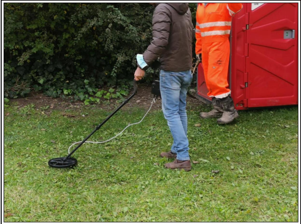
**Sondaggio VG3-Rilievo masse metalliche**
