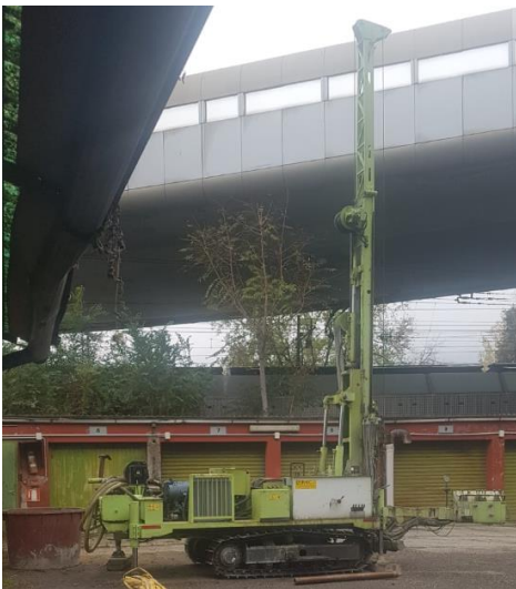
Figura 2: Perforatrice Nenzi Gelma 1 carro cingolata, specifiche tecniche
