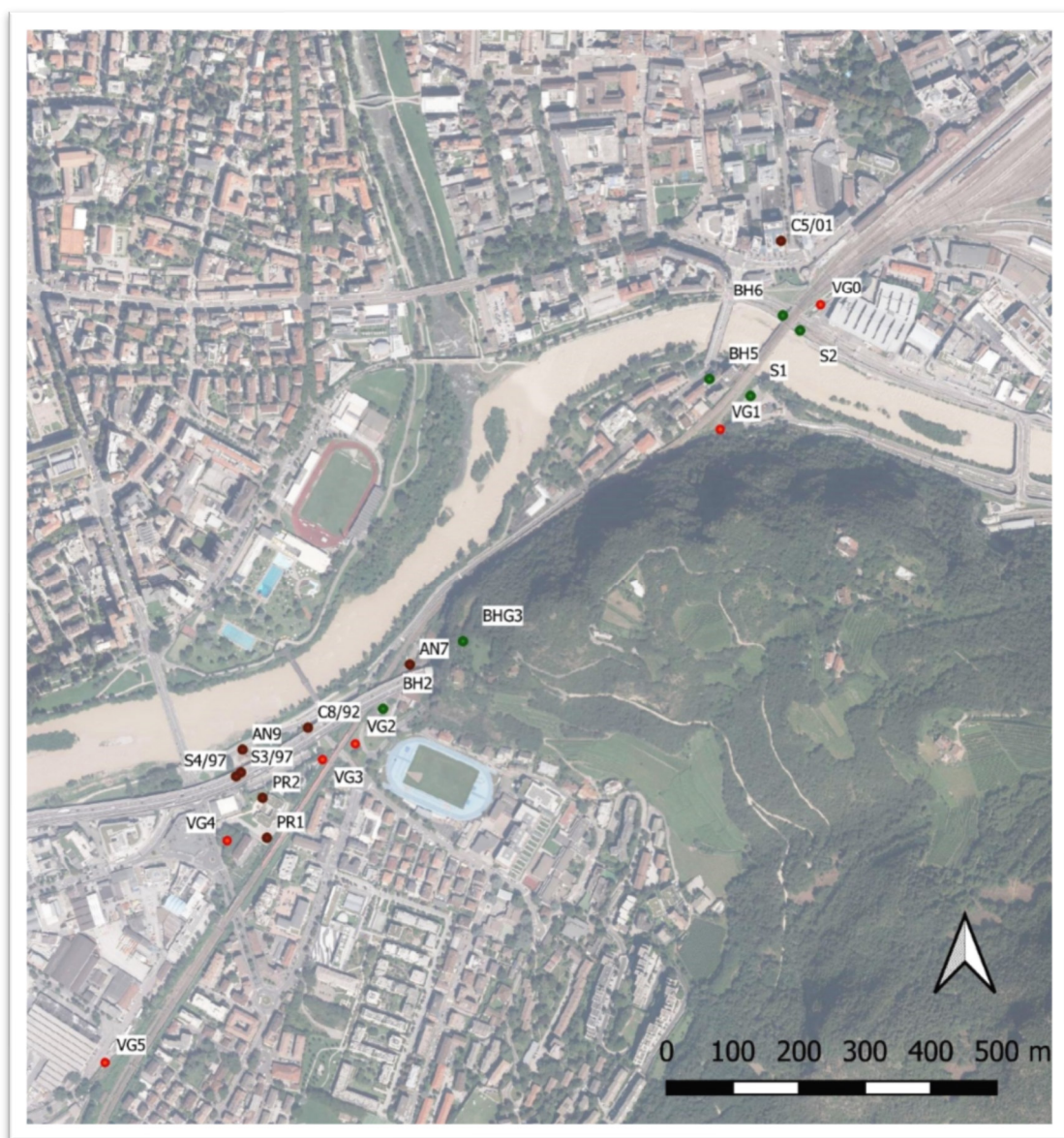
Figura 5: Ubicazione sondaggi geognostici
