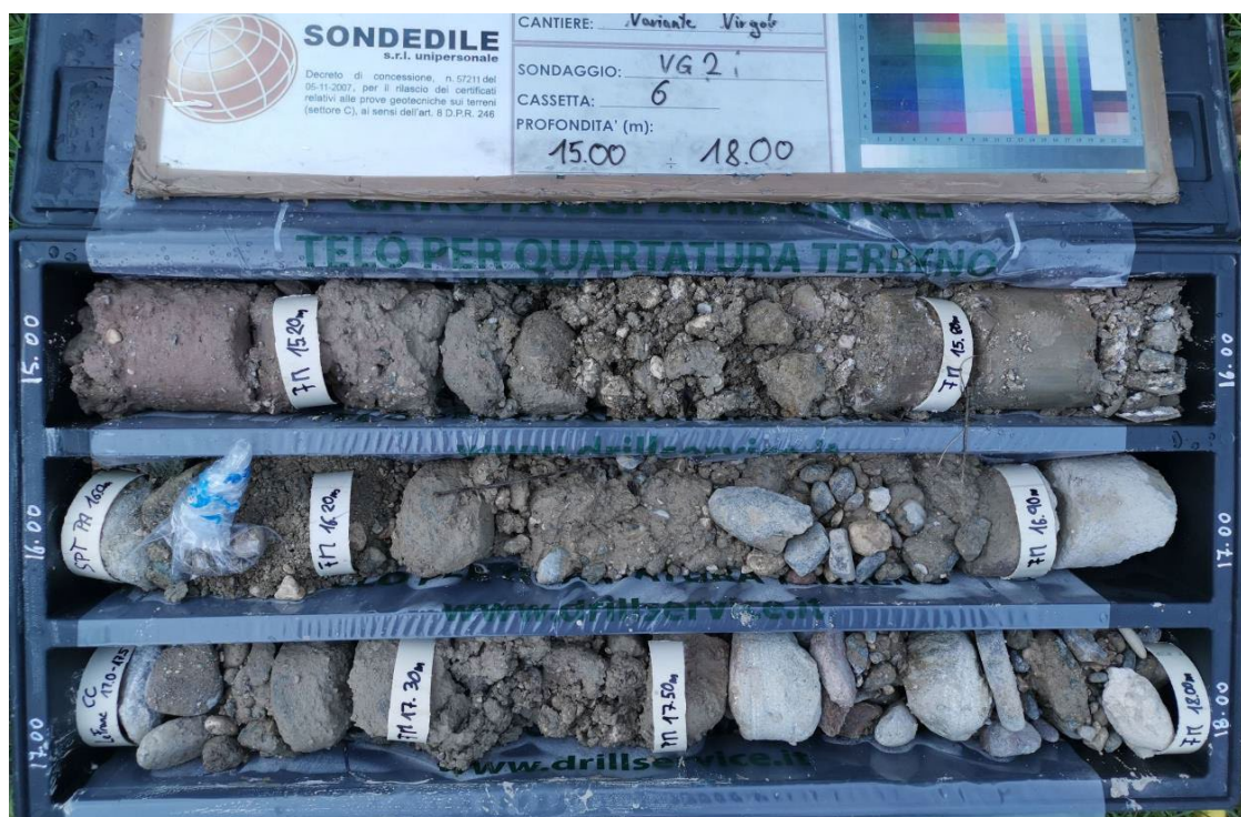
Figura 5: Deposito alluvionale al sondaggio VG2
