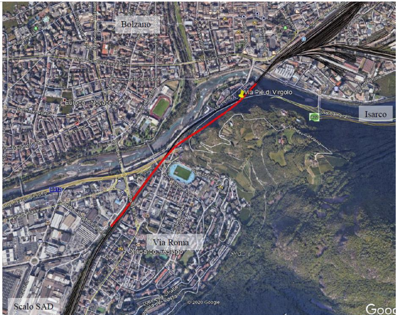
Figura 5 – Configurazione della linea allo stato di fatto (nero) e di progetto (rosso)
