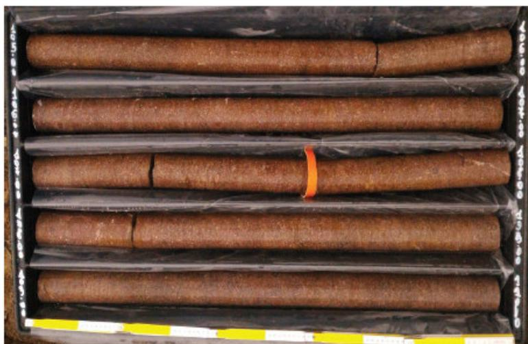
Figura 23. Formazione di Gries nel foro di sondaggio BHG7, tra i 105 ed i 110 m da p.c.
