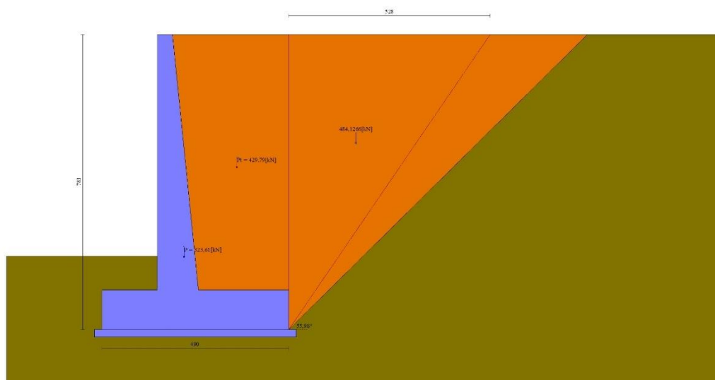
Fig. 3 - Cuneo di spinta (combinazione statica) (Combinazione n° 1)
