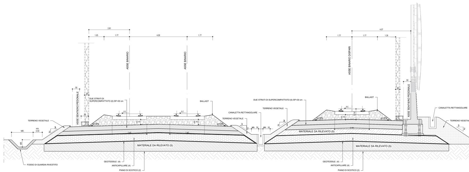
PIANTA PER SEZIONE TIPO A SINGOLO BINARIO IN RILEVATO - RI02
