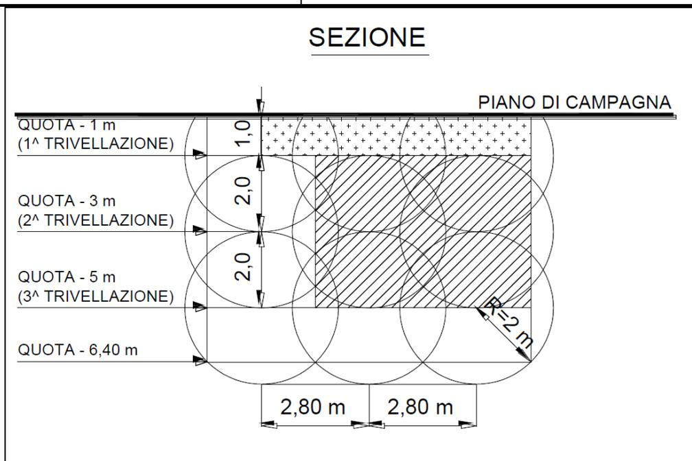
**Figura 10-2 – Schema della bonifica profonda – in sezione**
