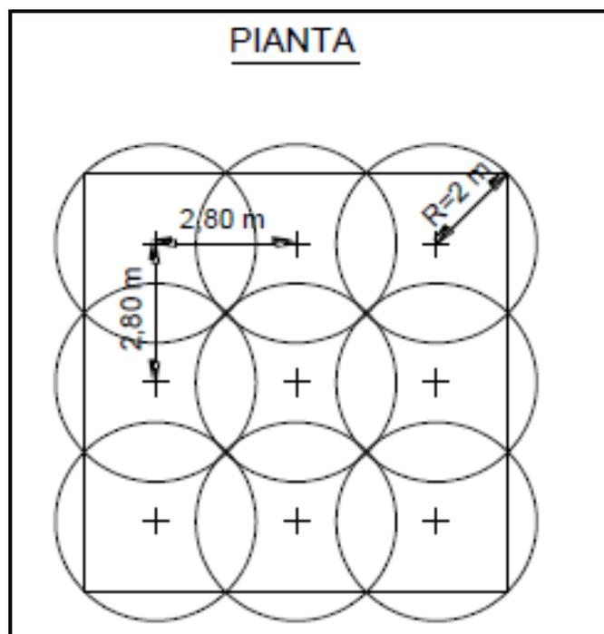
Figura 10-1 – Schema della bonifica profonda – in pianta
