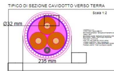
Figura 4-8: Esempio di cavo di collegamento a 66 kV e tipici di sezione
