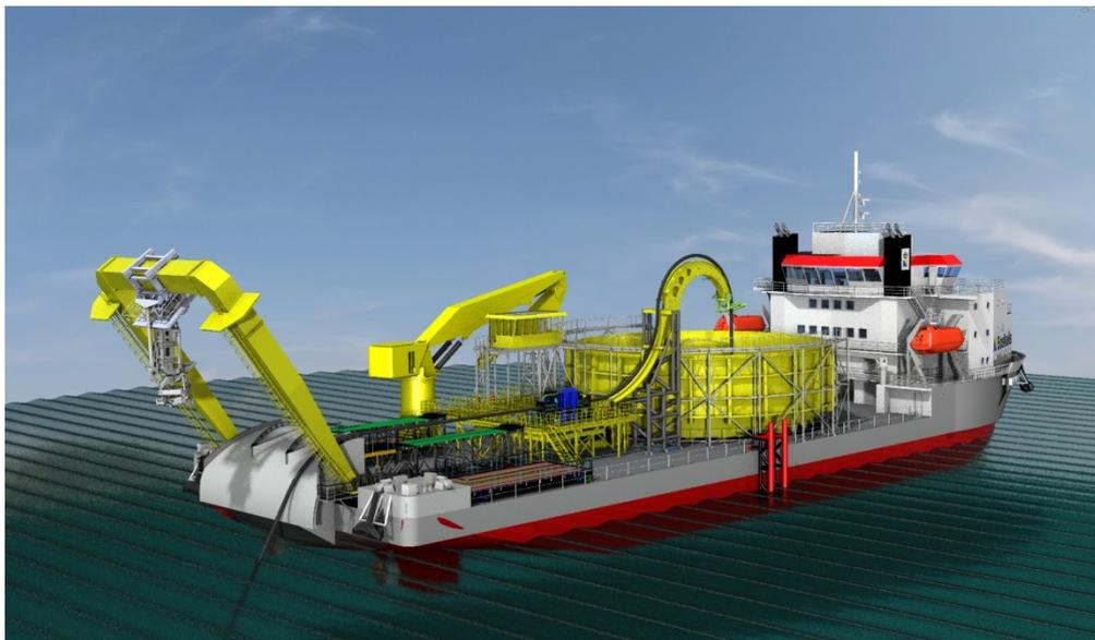
Figura 4-17: Esempio di nave posa cavo
