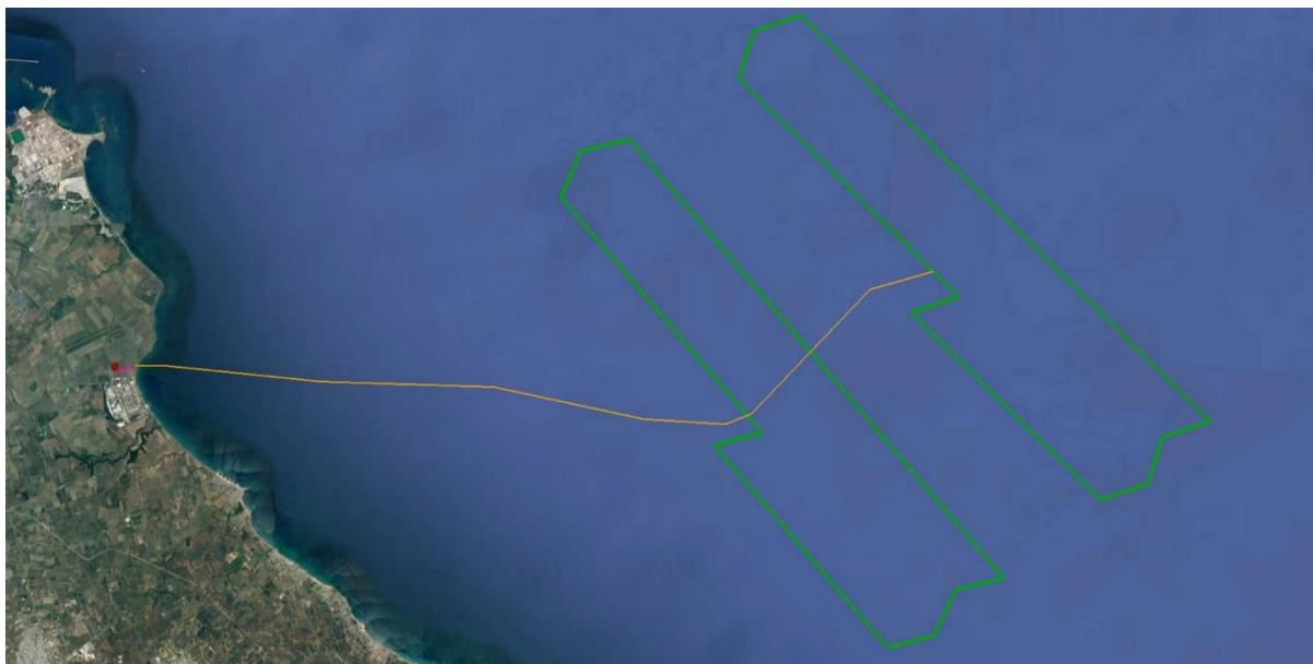
Figura 3:3: Vista del tracciato preliminare del cavidotto marino
