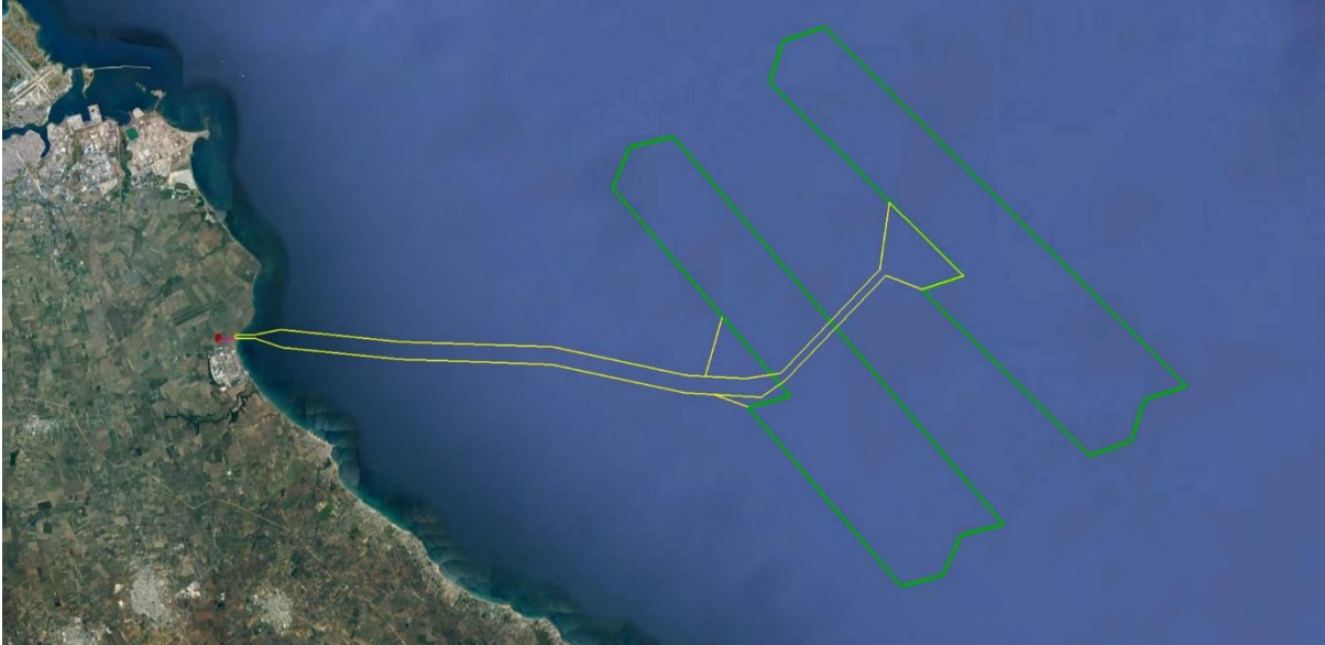
Figura 3:4: Vista del corridoio dei cavi marini 66kV
