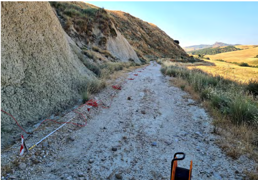
Prospezione Sismica a Rifrazione 1
