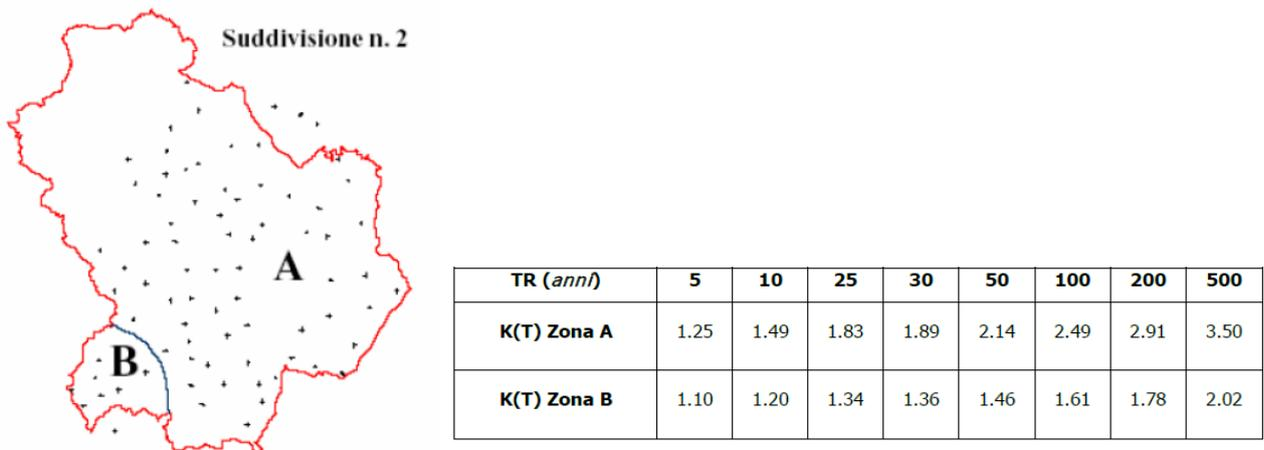
**Figura 8 - Aree omogenee e parametri al I livello di regionalizzazione per il calcolo della CPP**
