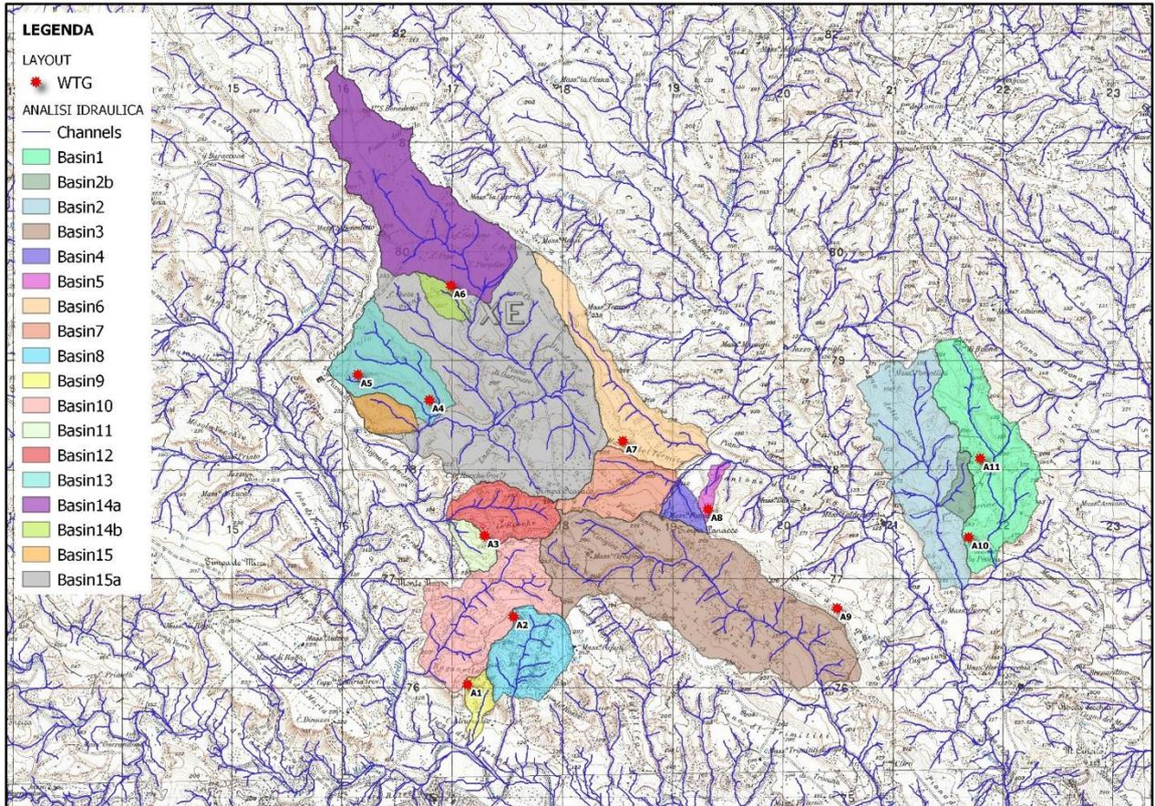
**Figura 10 – Bacini idrografici dell'area degli aerogeneratori (scala 1:35.000)**
