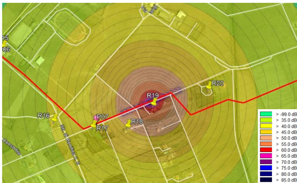
Figura 30: Mappa di iso-dB del cantiere lineare - recettore R19
