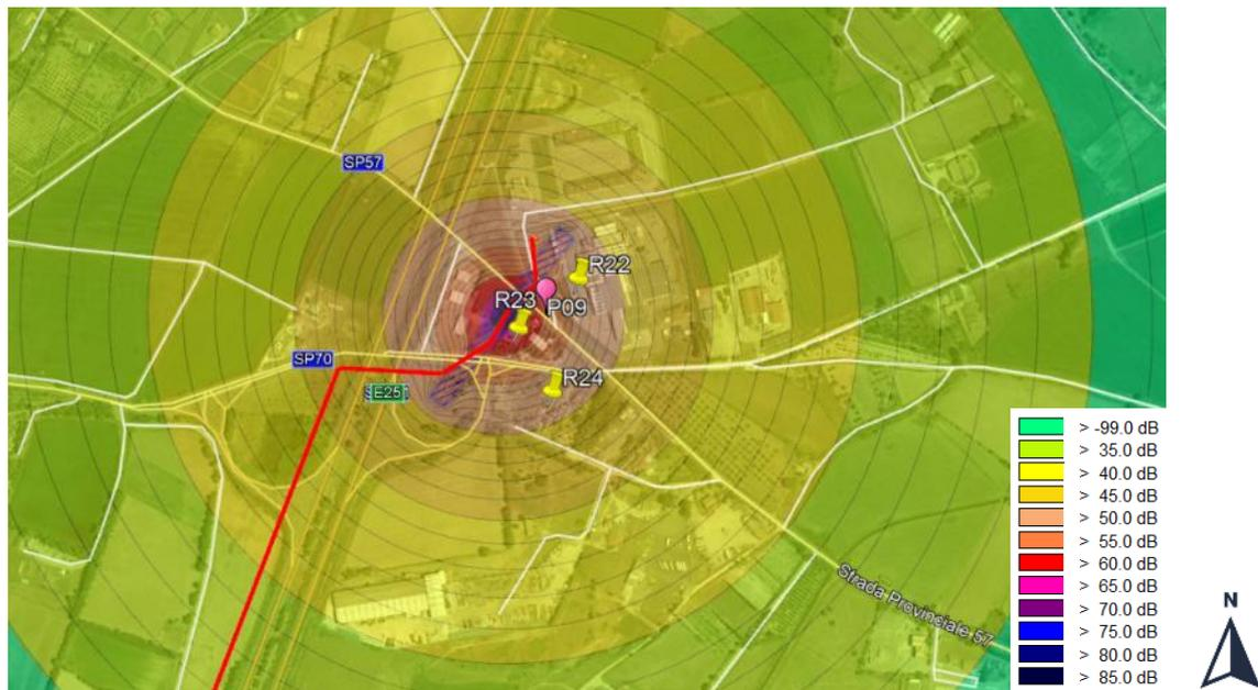
Figura 35: Mapa di iso-dB del cantiere lineare - recettore R22-R23-R24
