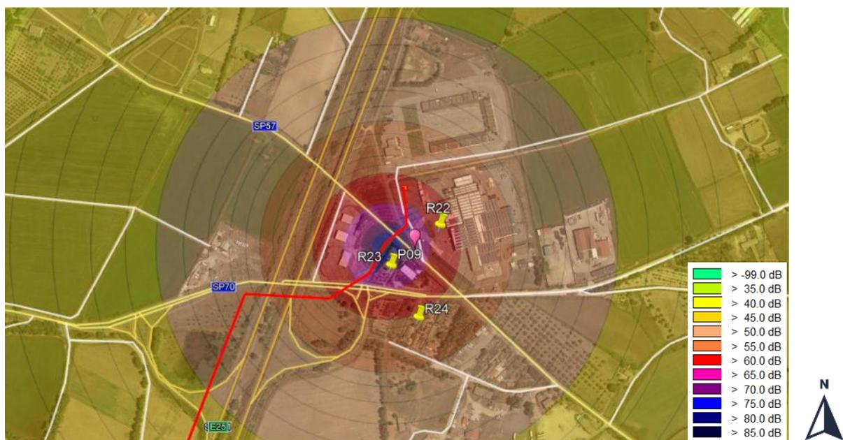
Figura 36: Mapa di iso-dB del cantiere in trivellazione Strada Prov. SP n.70 - recettore R22-R23-R24
