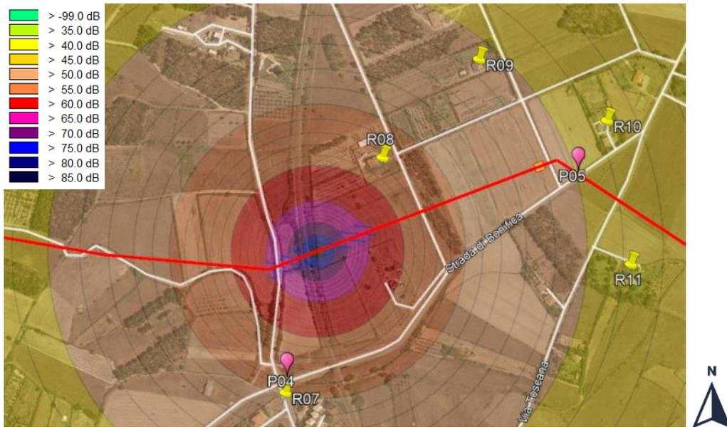
Figura 20: Mappa di iso-dB del cantiere in trivellazione F.S. Cagliari-Golfo Aranci - recettore R08-R07
