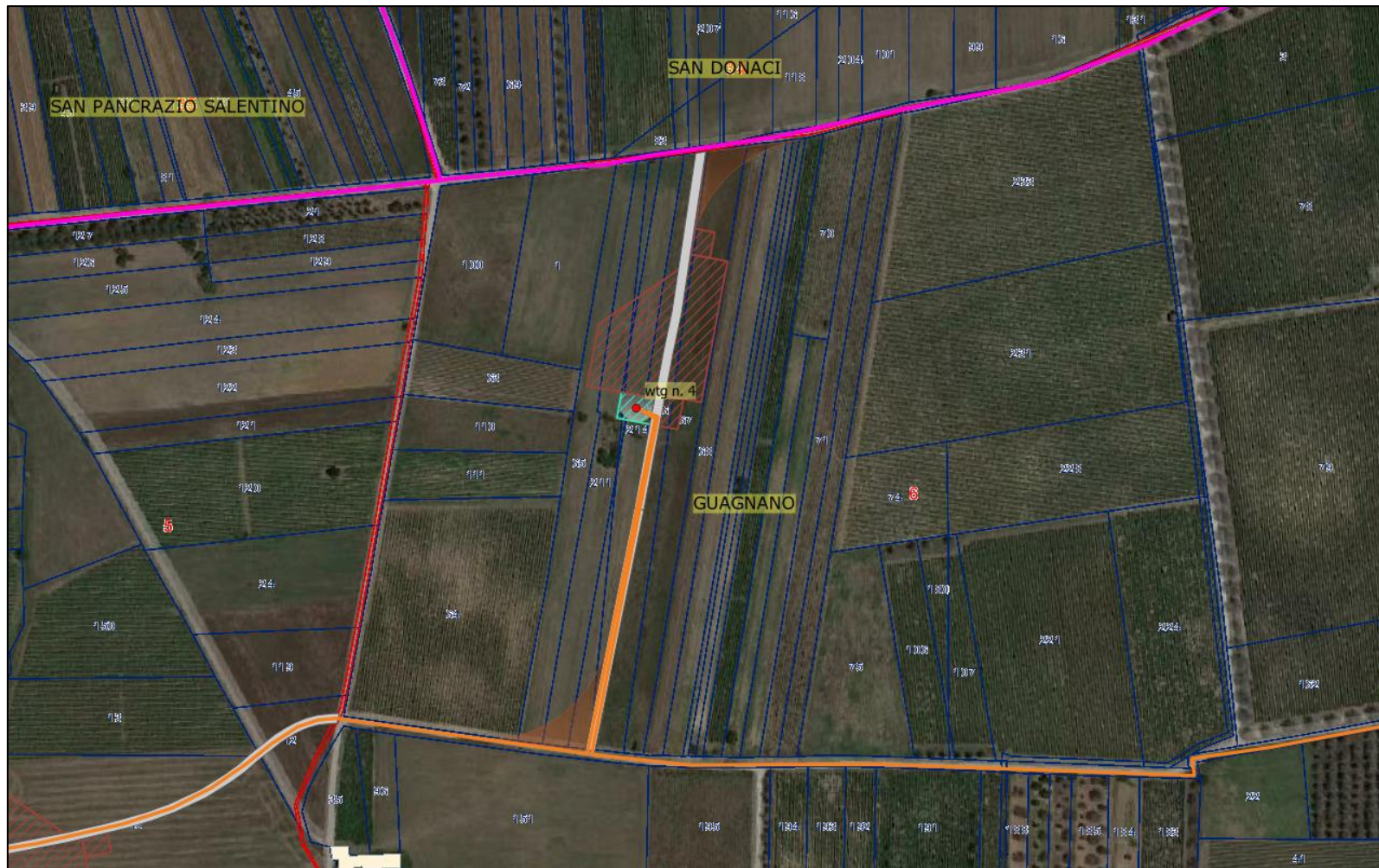
WTG 4: Accesso da sc attraverso slargo in normale senso di marcia. Proseguendo, attraverso ad uno slargo si accede alla strada interpodereale per l'accesso alla WTG 3
