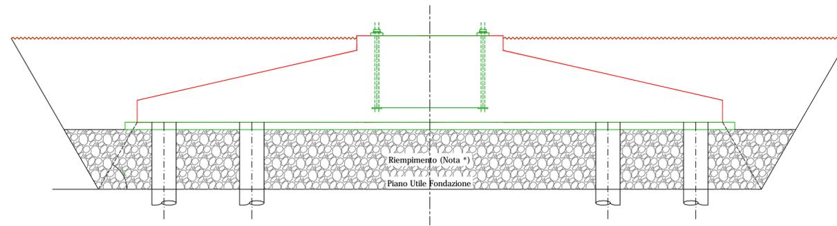
SEZIONE DI SCAVO CON PALI DI FONDAZIONE
