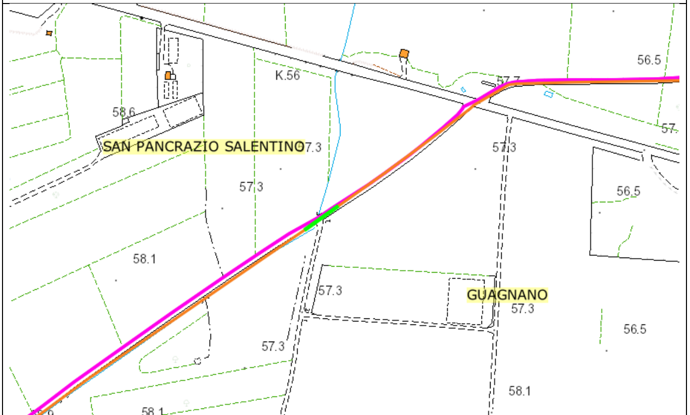
Intersezione cavidotto MT con reticolo idrografico (blu reticolo - verde tratto in TOC - arancione cavidotto interrato)
